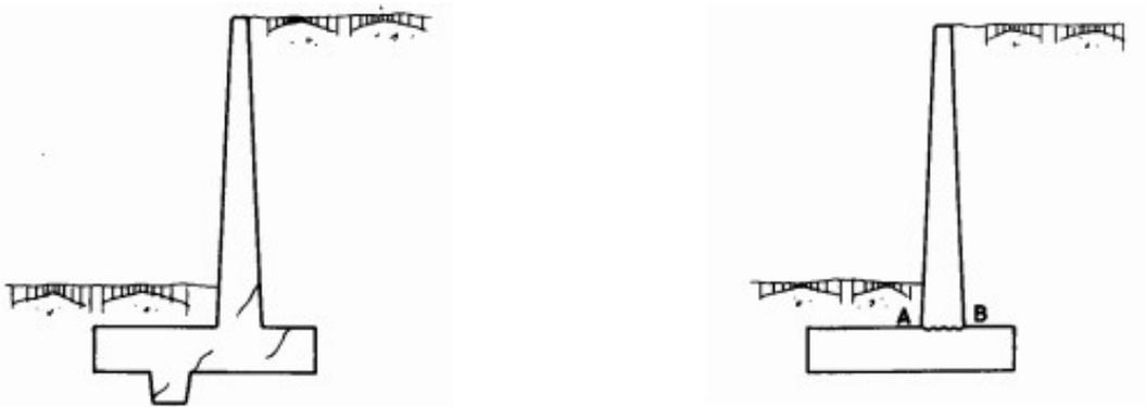
Dibujo 6. Rotura por esfuerzo cortante
