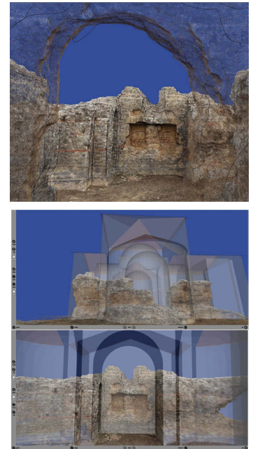
Fig. 6 Vista de la nube de puntos conjuntamente con el modelo volumétrico vectorial de las principales aristas (líneas negras). Los puntos del primer plano se aprecian separados mientras que los de la pared posterior dan la impresión de continuidad
