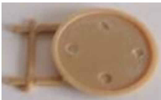
71. Figura. Marca habitual debido al uso de expulsores.
