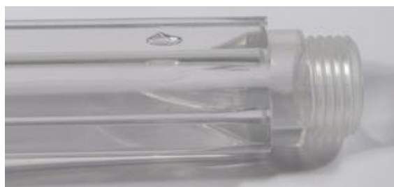
74. Figura. Atrapamientos de aire.
