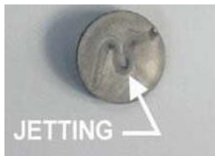
79. Figura. Efecto jetting.
