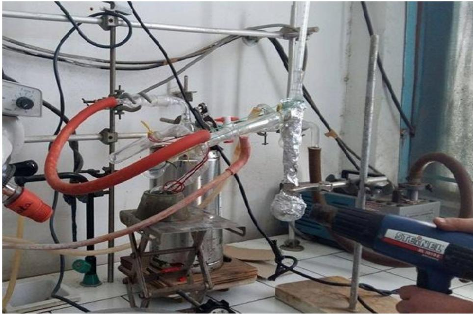
**Figure II-2 :** Dispositif de la distillation sous vide
