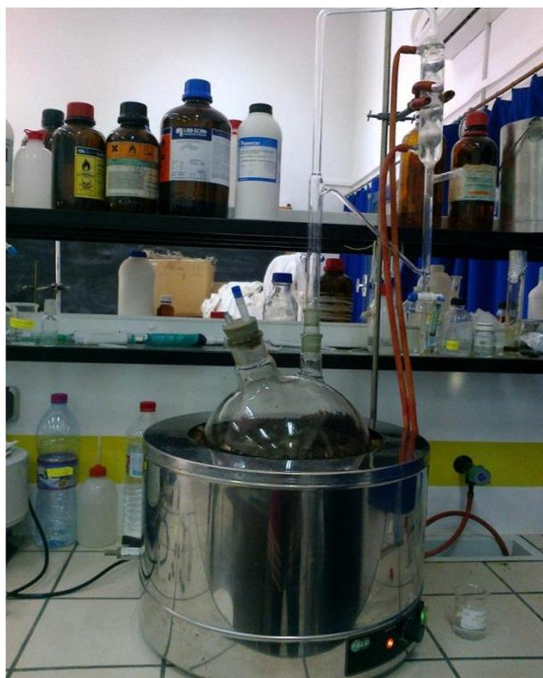
**Figure II-1** : Dispositif utilisé de l'hydrodistillation
