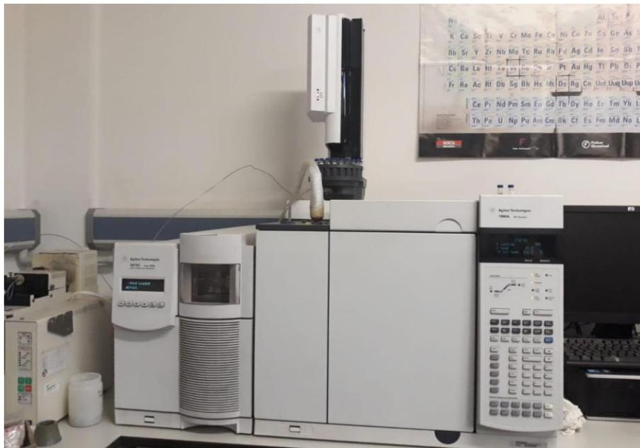
**Figure II-3 :** Dispositif de CPG-MS
