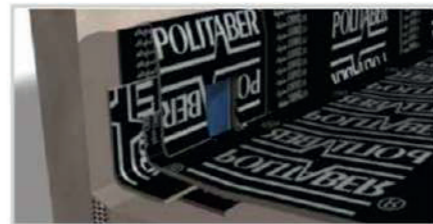
MEMBRANA CON PROTECCIÓN PESADA. (Membrana adherida)
