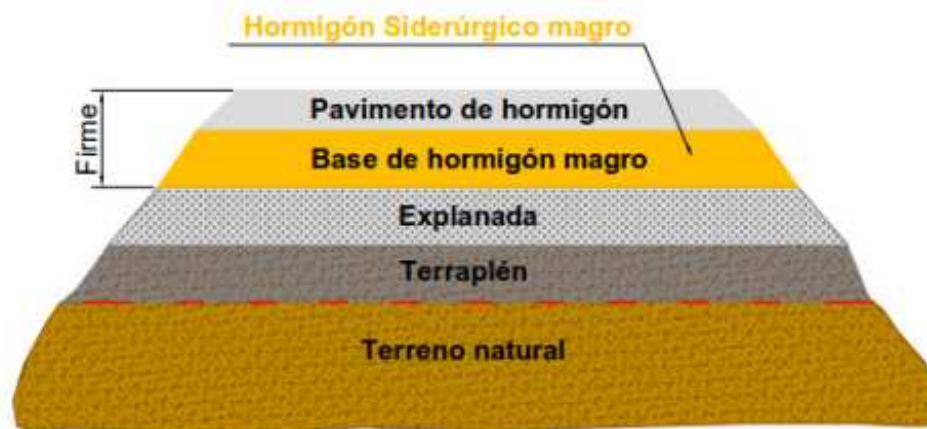
Ilustración 28. Hormigón magro vibrado en base de pavimento de hormigón [18]
