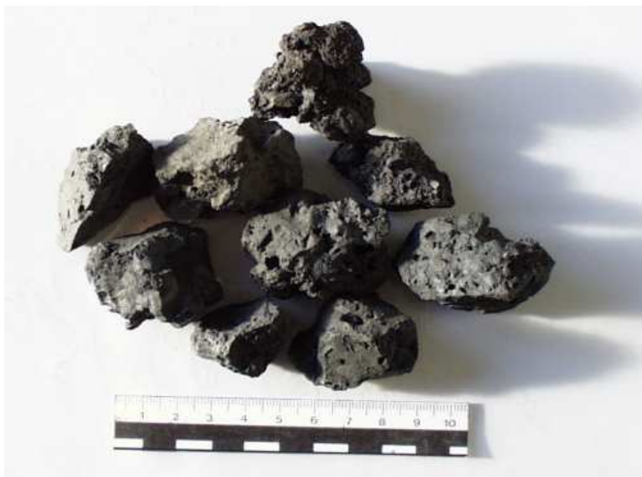
Ilustración 19. Escorias negras tras su extracción del horno y enfriamiento [CEDEX]
