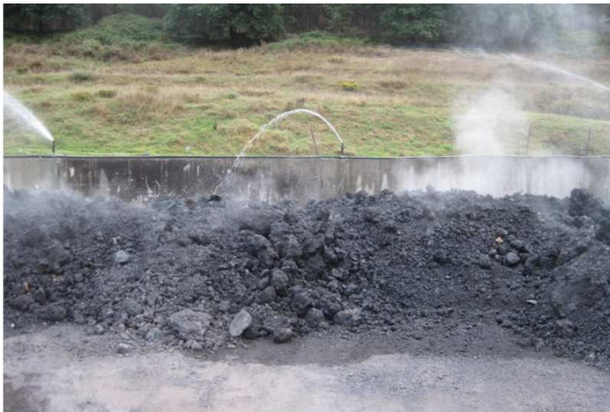
Ilustración 20. Procesos de envejecimiento y maduración de escoria negra [18]
