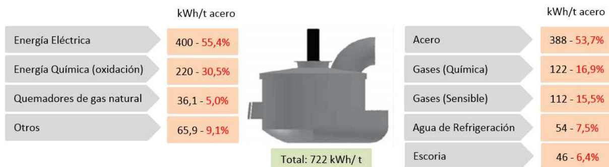
Gráfico 6. Balance energético de un horno de arco eléctrico [Elaboración propia]
