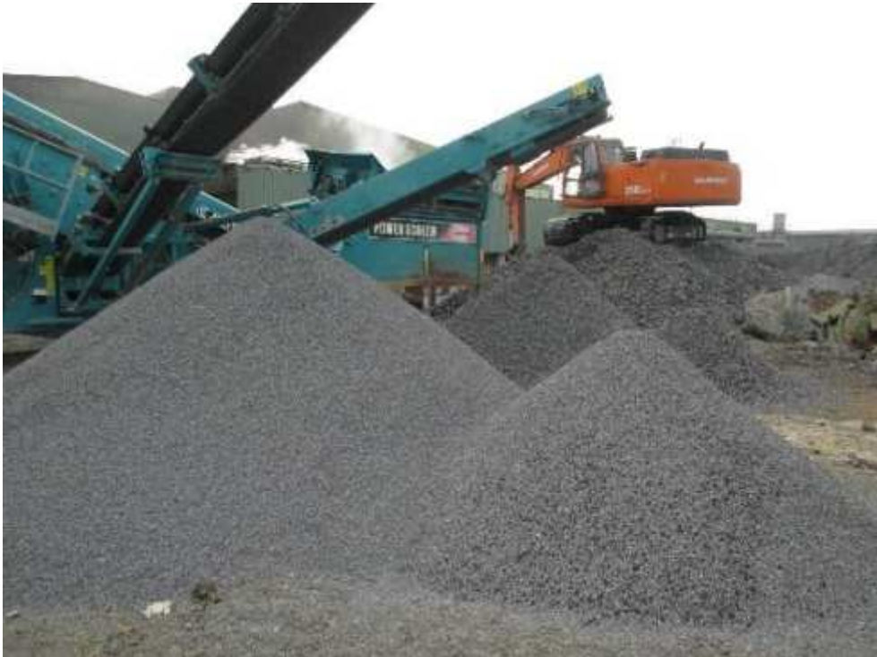
Ilustración 23. Acopio de fracciones diferenciadas de árido siderúrgico sobre capa impermeable [18]
