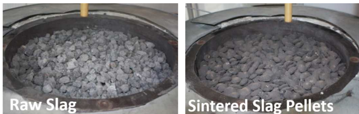
Ilustración 60. Escoria negra dentro del tanque de almacenamiento térmico de la planta piloto Julich Solar Tower [63]
