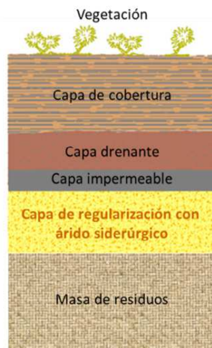
Ilustración 33. Capas de cubrición de vertederos [18]
