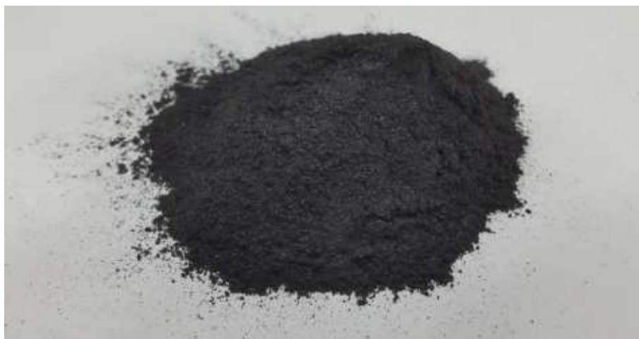
Ilustración 15. Cascarilla de laminación proveniente del proceso de laminación. [GERDAU DIACO S.A]
