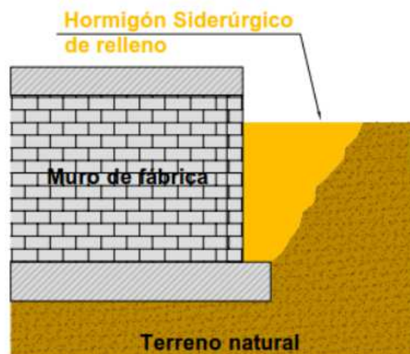
Ilustración 26. Hormigón de relleno no estructural en trasdós de muro de fábrica [18]
