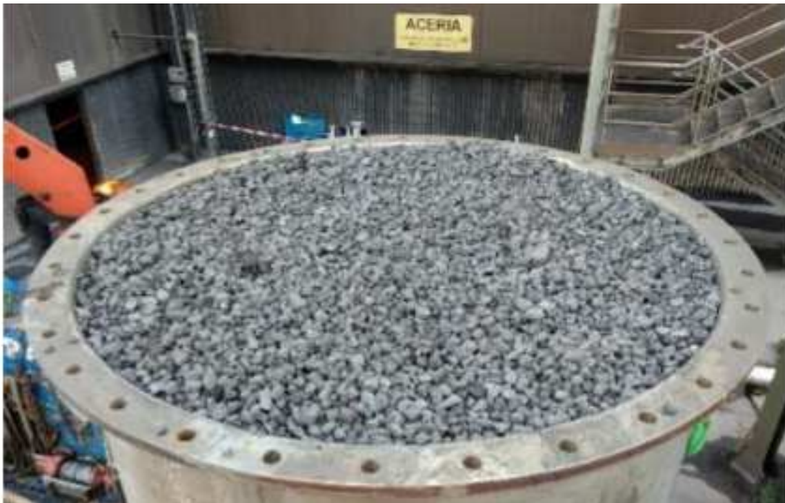
Ilustración 52. Tanque de lecho fijo de ArcelorMittal cargado de escoria negra [52]
