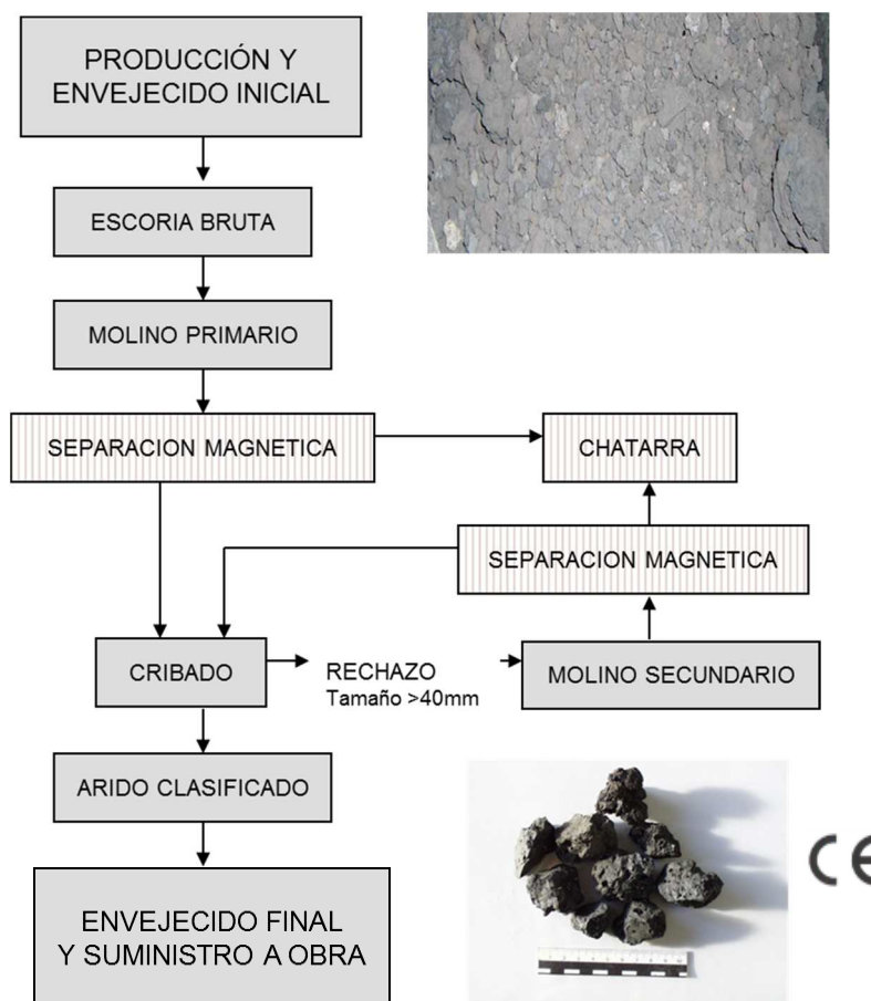
Gráfico 3. Tratamientos previos de la escoria para su utilización como árido siderúrgico [APB]
