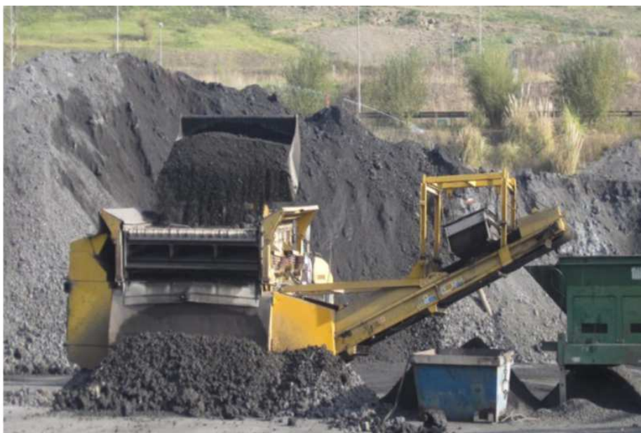
Ilustración 22. Sistema de cribas de material granular procedente del tratamiento de escoria negra [18]
