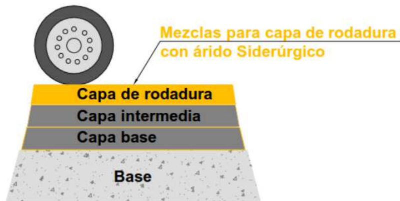
Ilustración 30. Hormigón bituminoso con árido siderúrgico en pavimento flexible [18]
