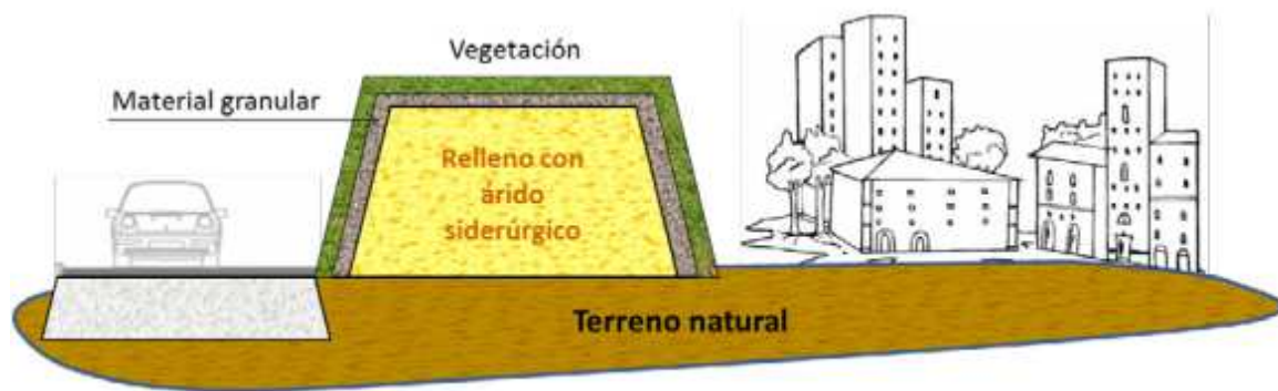
Ilustración 35. Apantallamiento sónico en forma de dique [18]
