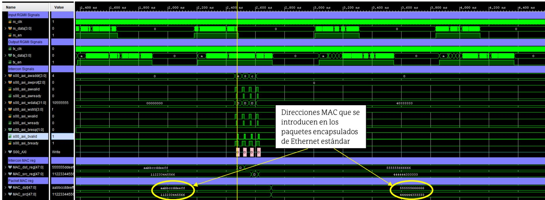
Figura 17. Simulación de accesos desde PS con AXI Traffic Generator.
