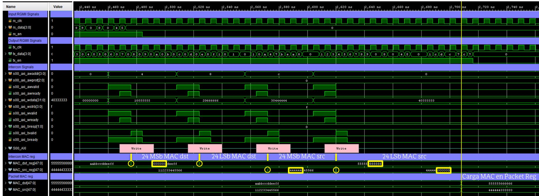
**Figura 18.** Ampliación de captura de simulación de accesos desde PS con AXI Traffic Generator.
