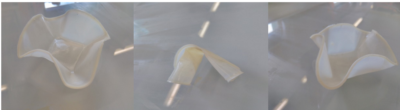
36. Irudia: 5CL5050DG11 filme sareatua, hasierako egoeran(ezkerra), behin-behineko forman(erdia) eta hasierako forma berreskuratuan(eskuina).
