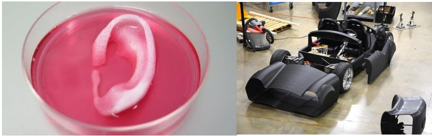
Figura 1. 1: Oreja [5] y automóvil fabricados por impresión 3D [6]
