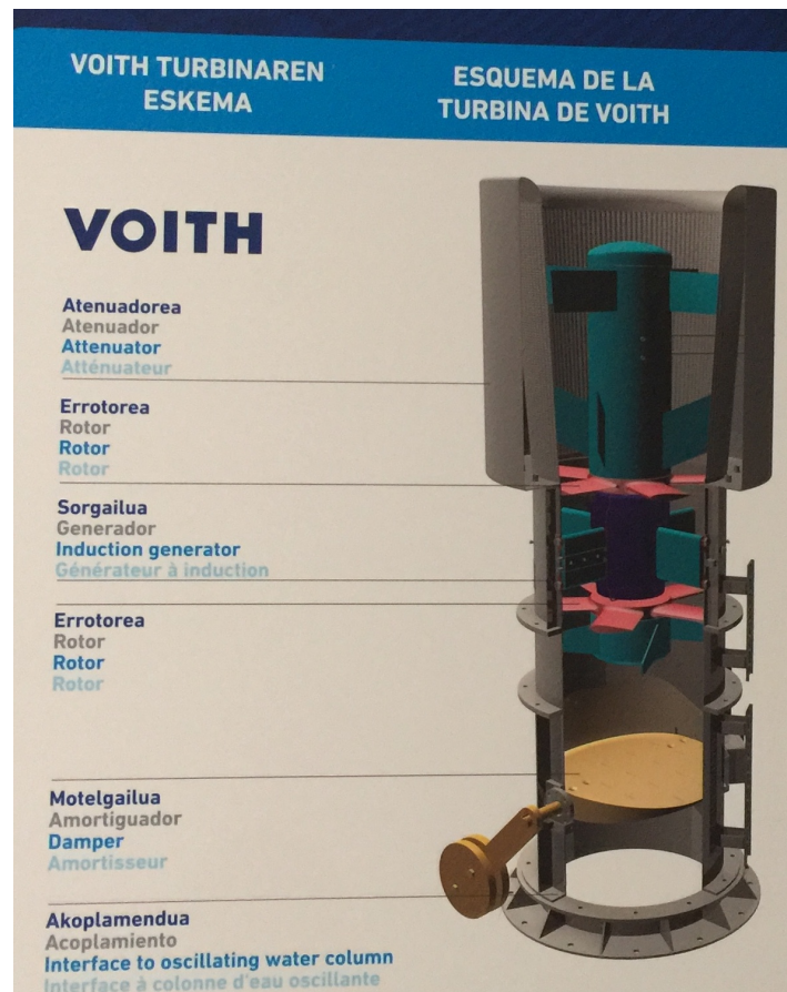
Figura 8: Esquema de la turbina [Colección personal].
