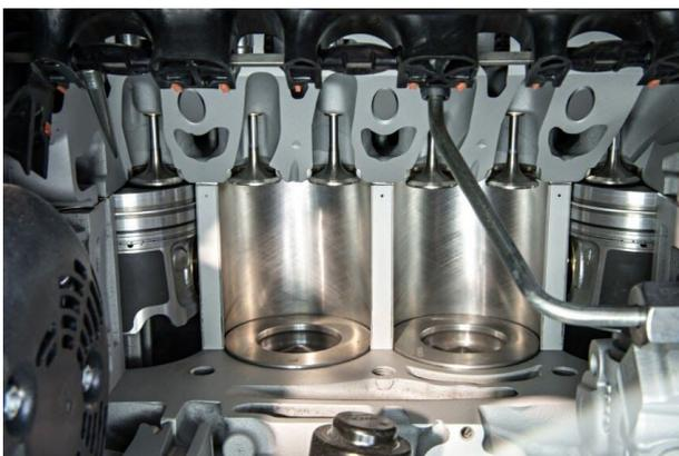
Figura 7.1 *Grupo pistón del B47 montado en los cilindros*
