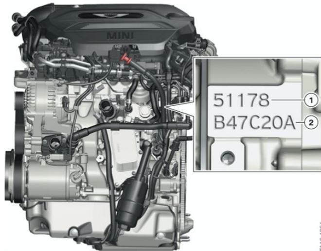
Figura 5.1 Motor BMW B47 C20 montado
