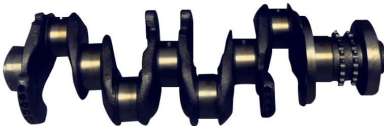
Figura 7.4.4 *Cigüeñal real del motor B47*
