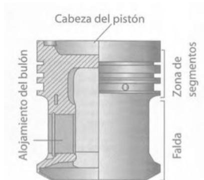
Figura 7.1.1 *Partes principales del pistón [11]*
