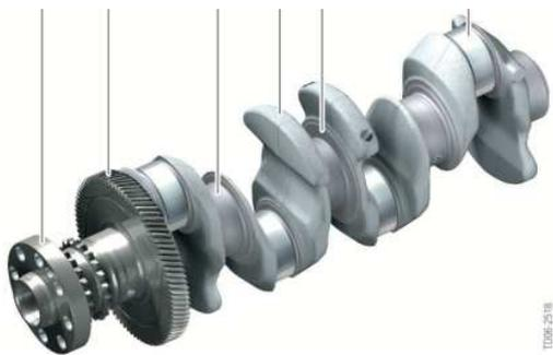
Figura 7.4.2 Cigüeñal de motor de BMW de 4 cilindros en línea (N47)
