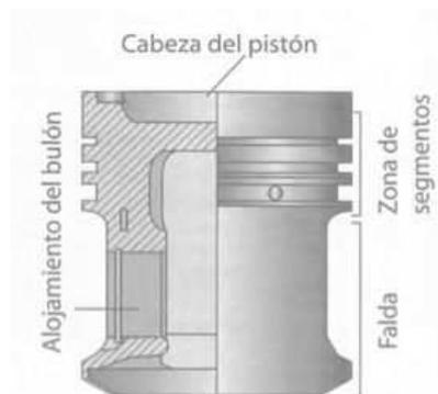
Figura 7.1.1 *Partes principales del pistón [11]*
