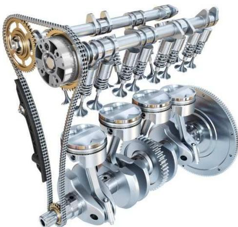
Figura 2.4 *Motor de combustión interna alternativo (4 cilindros)*
