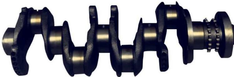
Figura 7.4.4 *Cigüeñal real del motor B47*
