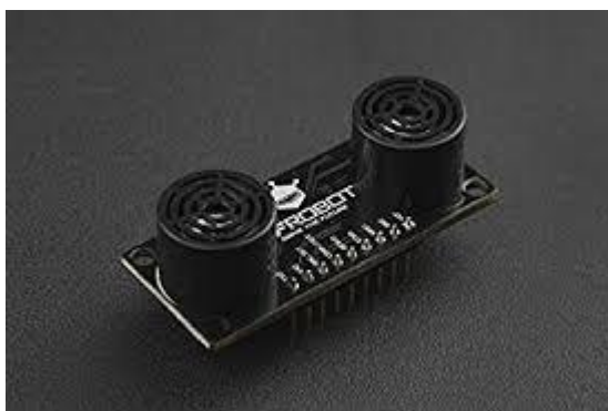
Irudia 13 URM 37 V5.0 ultrasoinu sentsorea
