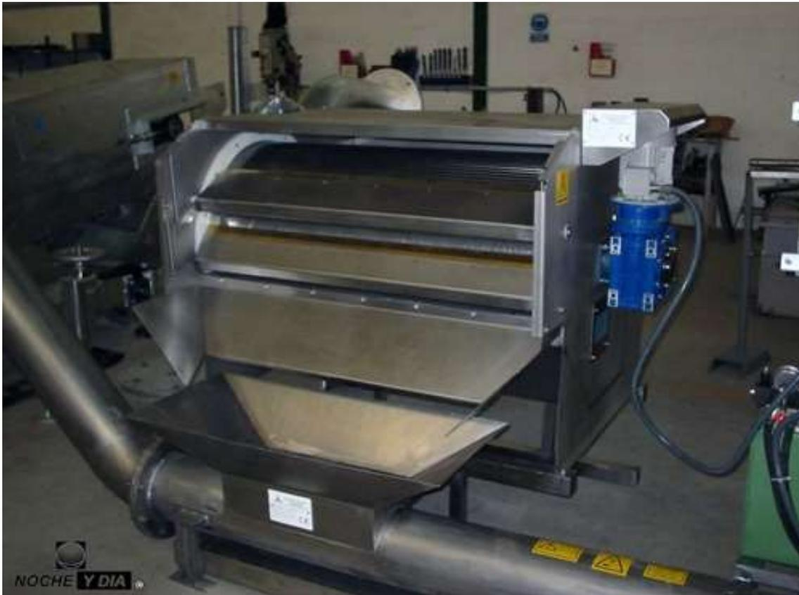
Figura 21: Tamiz rotativo. Fuente: <http://www.nocheydia.net/productos/tamices/> [24]
