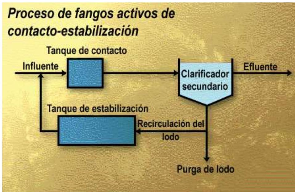
Figura 25: Proceso fangos activados contacto-estabilización.
