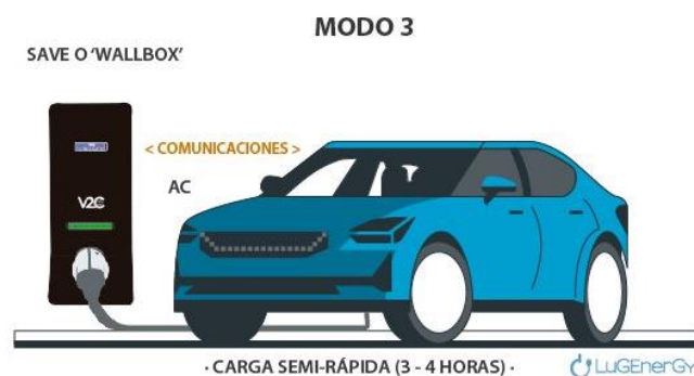
Figura.4. Modo 3 de carga VE. (Fuente: LuGEnerGy)
