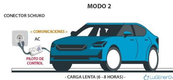
Figura.3. Modo 2 de carga de VE. (Fuente: LuGEnerGy)
