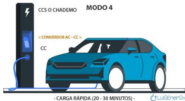
Figura.5. Modo 4 de carga VE. (Fuente: LuGEnerGy)
