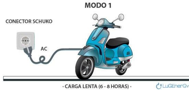
Figura.2. Modo 1 de carga de VE. (Fuente: LuGEnerGy)
