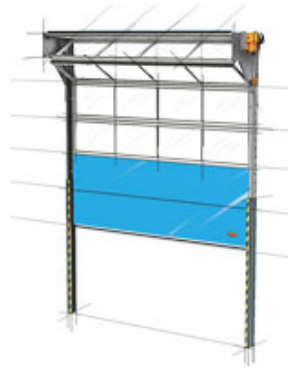
Ilustración 4.28. Sistema puerta corredera abierta.
