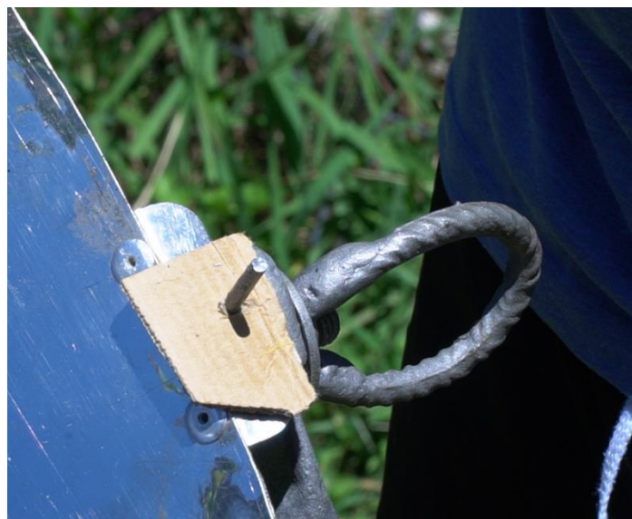
Figura 4-12. Calibrador manual para encontrar la posición óptima tanto en elevación como en azimut de la cocina solar (el cartón fue provisional, actualmente está pintada la zona plateada para observar mejor la sombra)
