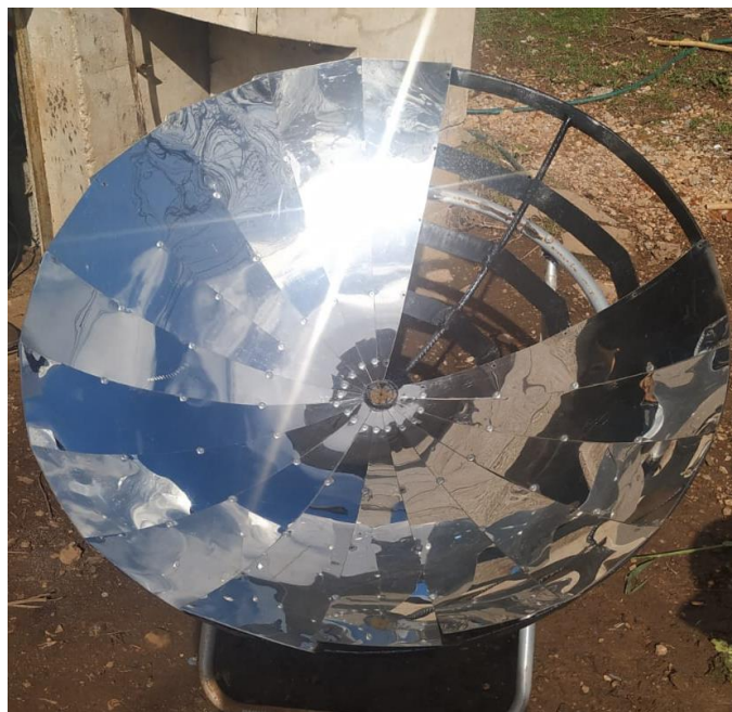
Figura 4-8. Fase de montaje de los reflectores del captador de la cocina
