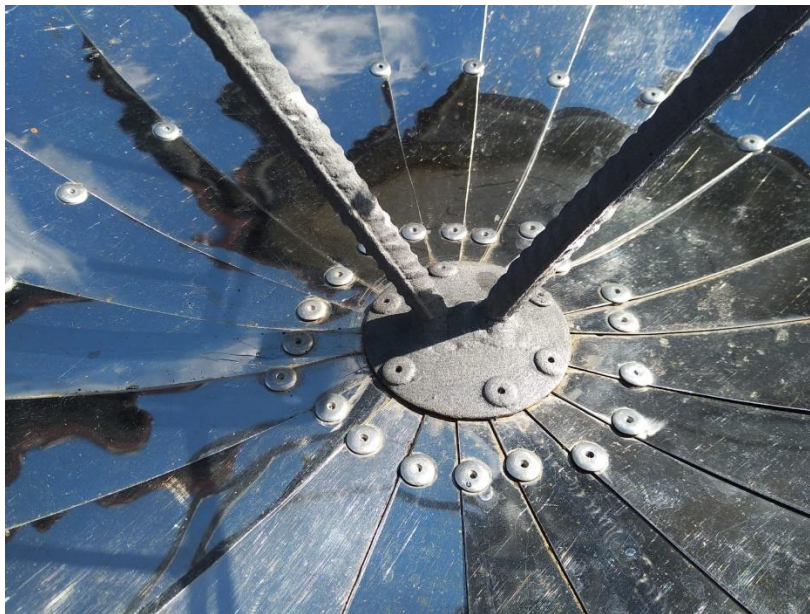
Figura 4-14. Base del soporte de la cazuela de la cocina solar
