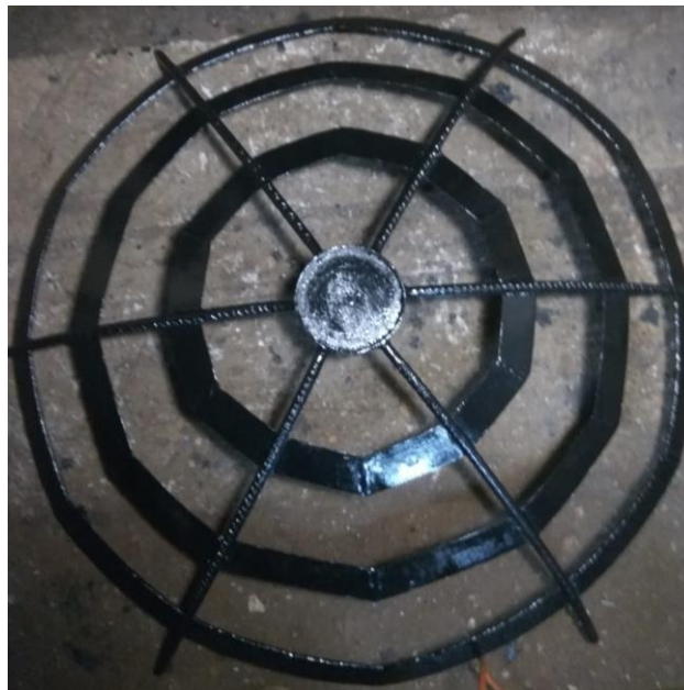
Figura 4-7. Estructura soporte de las chapas reflectoras de la cocina vista desde atrás
