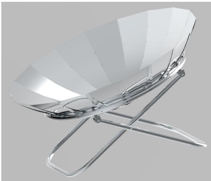
Figura 4-4. Modelado del primer prototipo de la cocina solar renderizado. (Fuente: Solid Edge)
