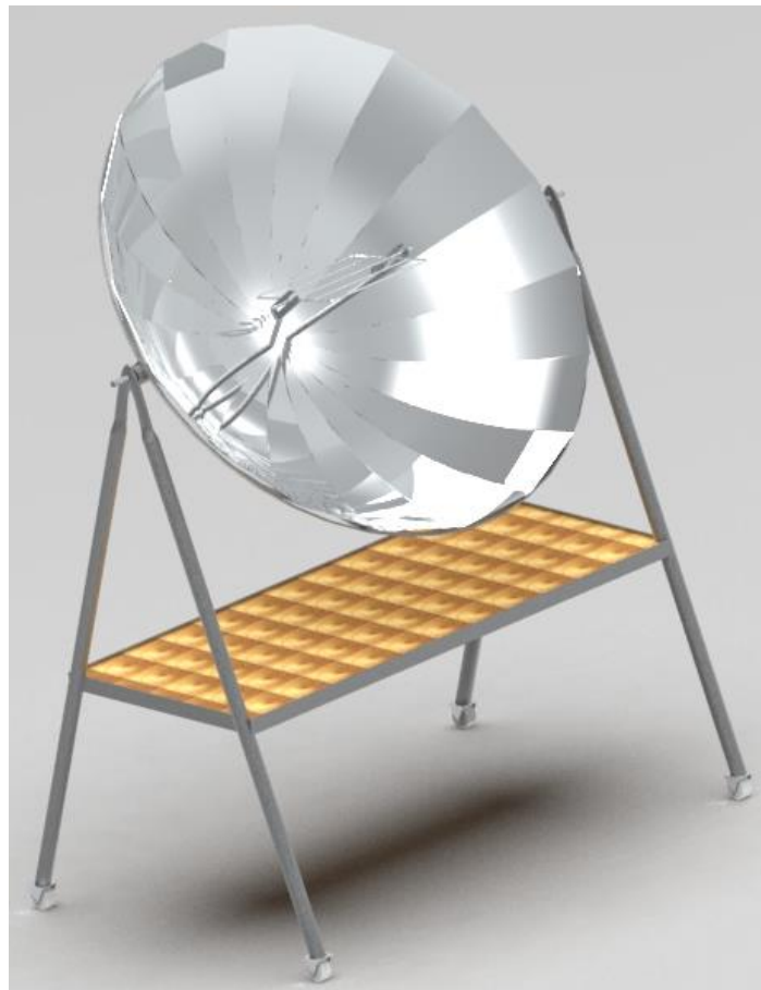
Figura 4-5. Modelado del segundo y definitivo prototipo de la cocina solar renderizado. (Fuente: Solid Edge)
