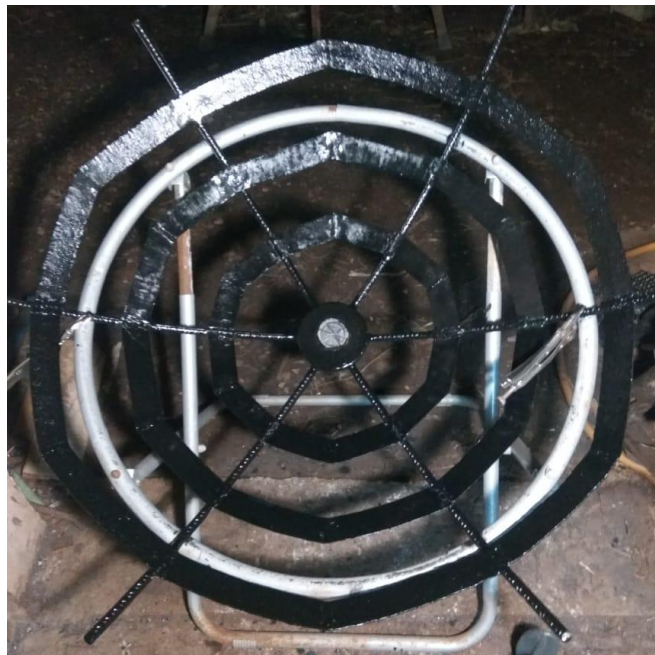
Figura 4-6. Estructura soporte de las chapas reflectoras de la cocina vista desde arriba
