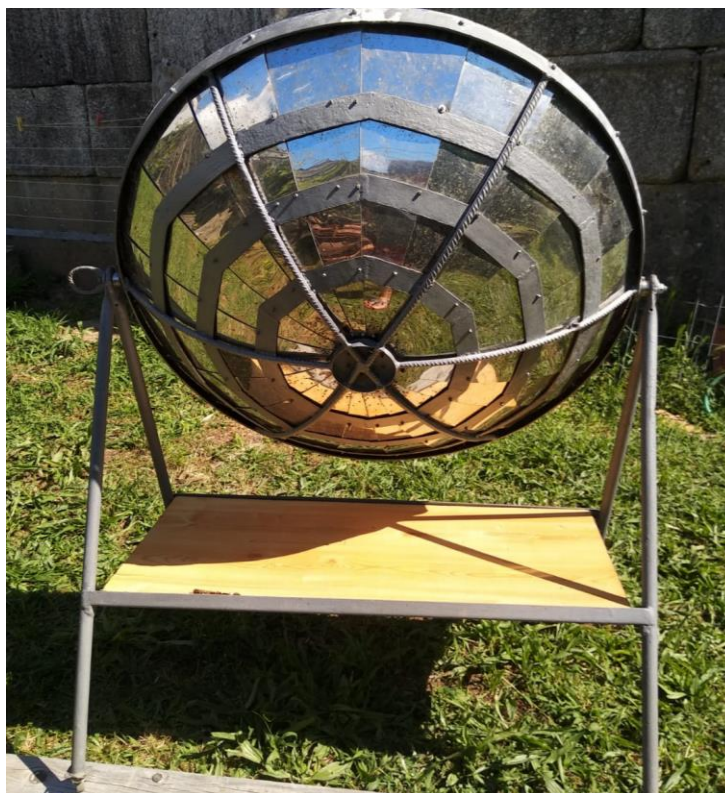
Figura 4-10. Cocina solar terminada (prototipo definitivo) vista trasera
