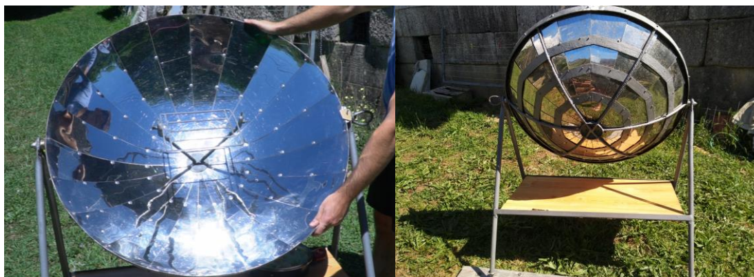
Figura 7-8. Prototipo elegido de la cocina solar fabricado
