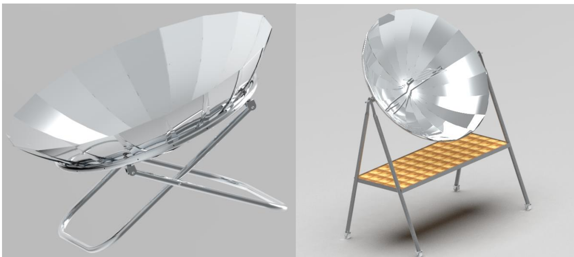
Figura 7-7. A la derecha el primer prototipo y a la izquierda el segundo de la cocina solar. (Fuente: Solid Edge)
