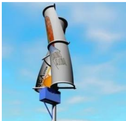
Irudia 1-7. Savonius aerosorgailua [9].
