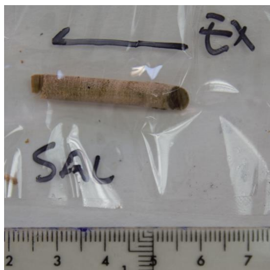
Figura 9.- Muestra de madera para el método semidestructivo.
