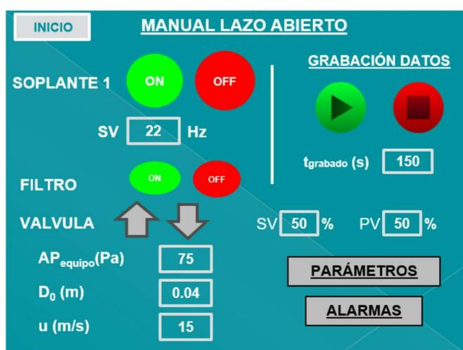
**Figura 3.3.** Pantalla del panel de control de manejo de la soplante.
