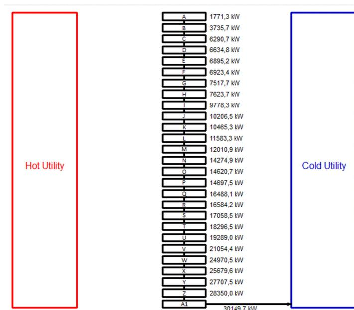
Figura 6. Diagrama de cascada para el proceso de la urea diseñado.
