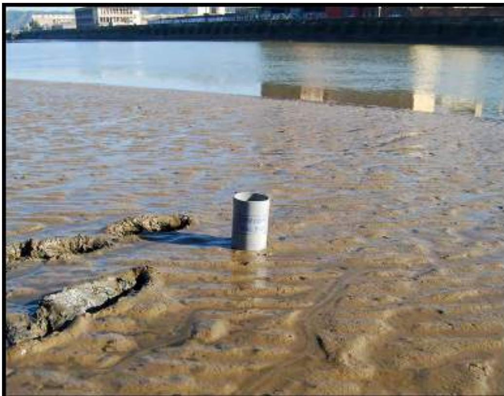
**Figura 2.4.** Recuperación de un sondeo corto intermareal mediante la inserción de un tubo hueco de PVC en el sedimento (Zorrotza, estuario del Nervión, Bizkaia).
