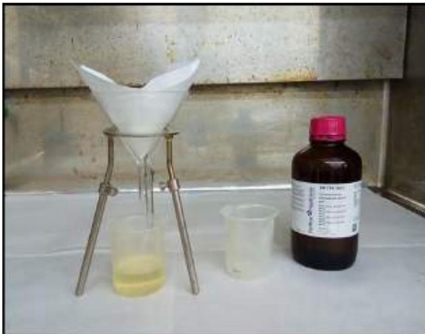
**Figura 2.11.** Materiales para el proceso de concentración de foraminíferos bentónicos por flotación en tricloroetileno.
