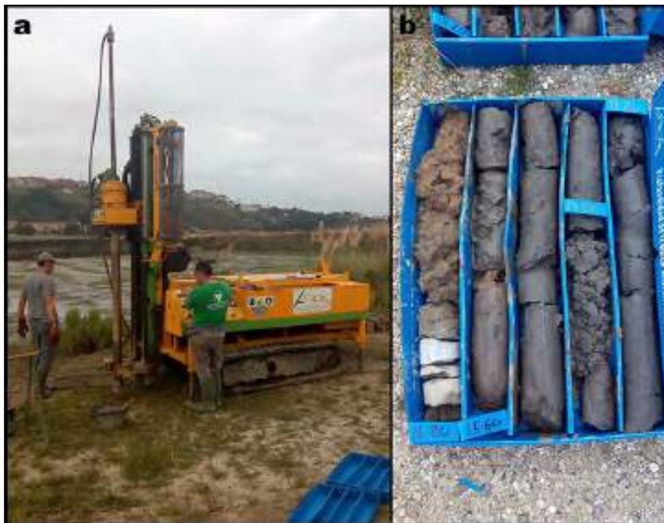
**Figura 2.7.** a) Perforación de los sondeos largos intermareales en el estuario del Saja-Besaya (Cuchía, Cantabria). b) Disposición de los testigos sedimentarios en cajas para su posterior muestreo en laboratorio.
