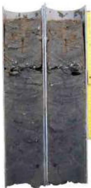
**Figura 2.8.** Aspecto interior de los testigos intermareales muestreados (Miengo 1, Cantabria) una vez abierto longitudinalmente.
