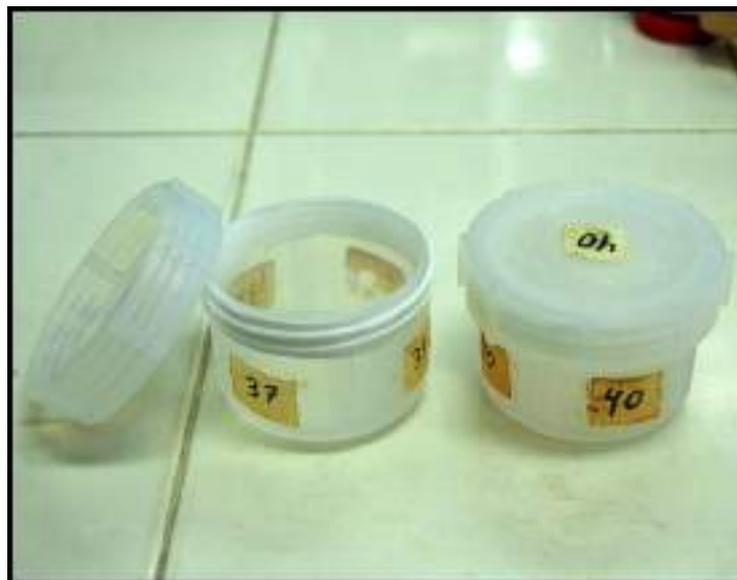
**Figura 2.13.** Recipientes de digestión Savillex numerados para la preparación de las muestras que fueron posteriormente analizadas por espectrometría alfa.
