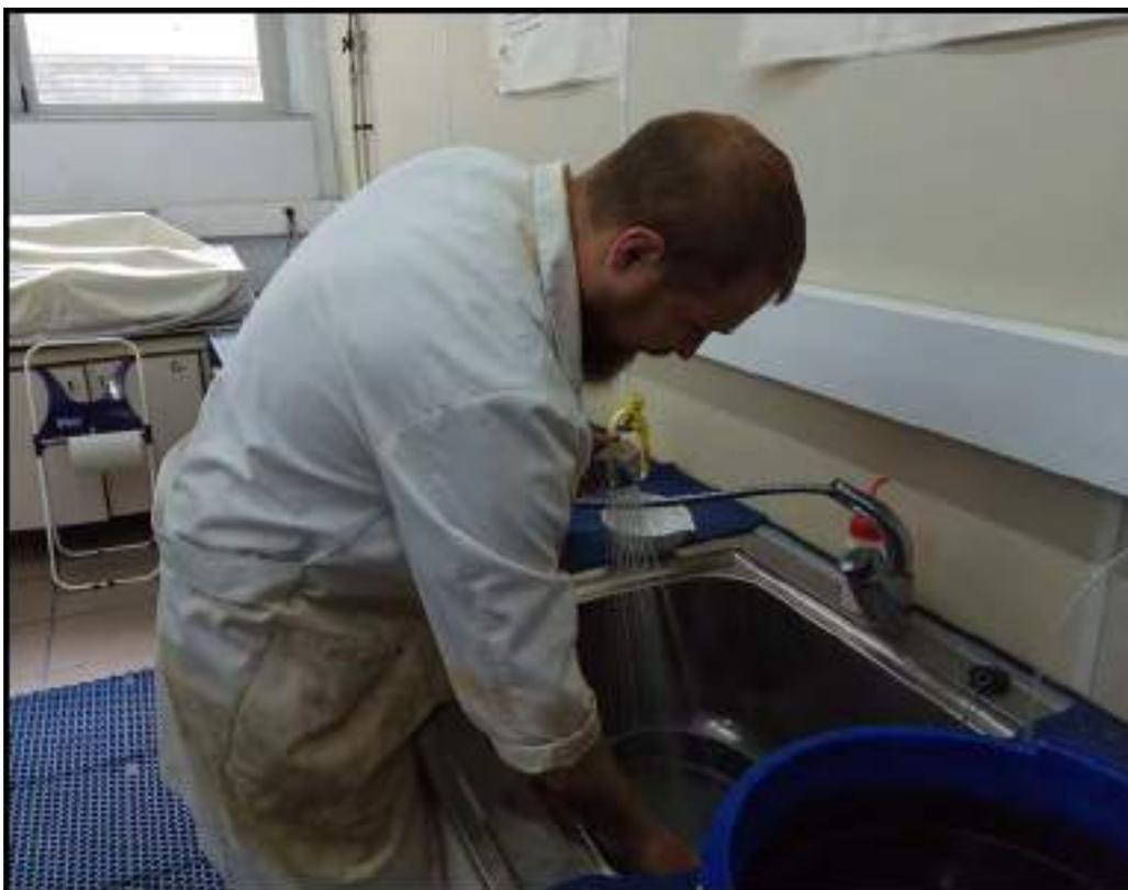
**Figura 2.10.** Proceso de levigado del sedimento con agua corriente a través de tamices con luces de malla 2 mm y 63  $\mu$ m.
