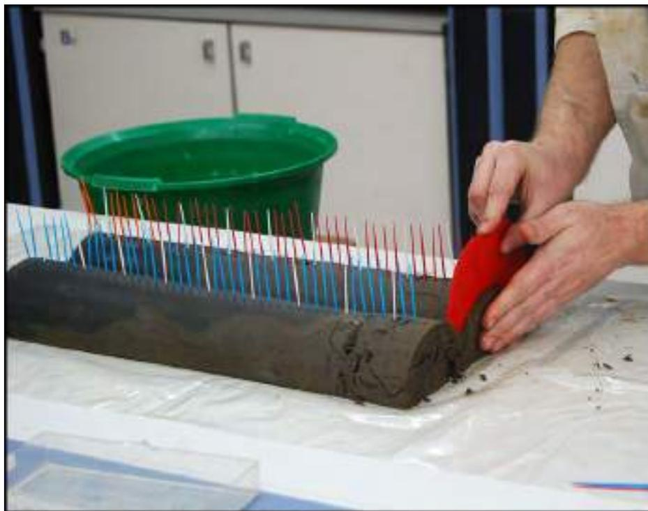
**Figura 2.9.** Muestreo en el laboratorio de un sondeo intermareal en secciones de 1 cm de espesor.
