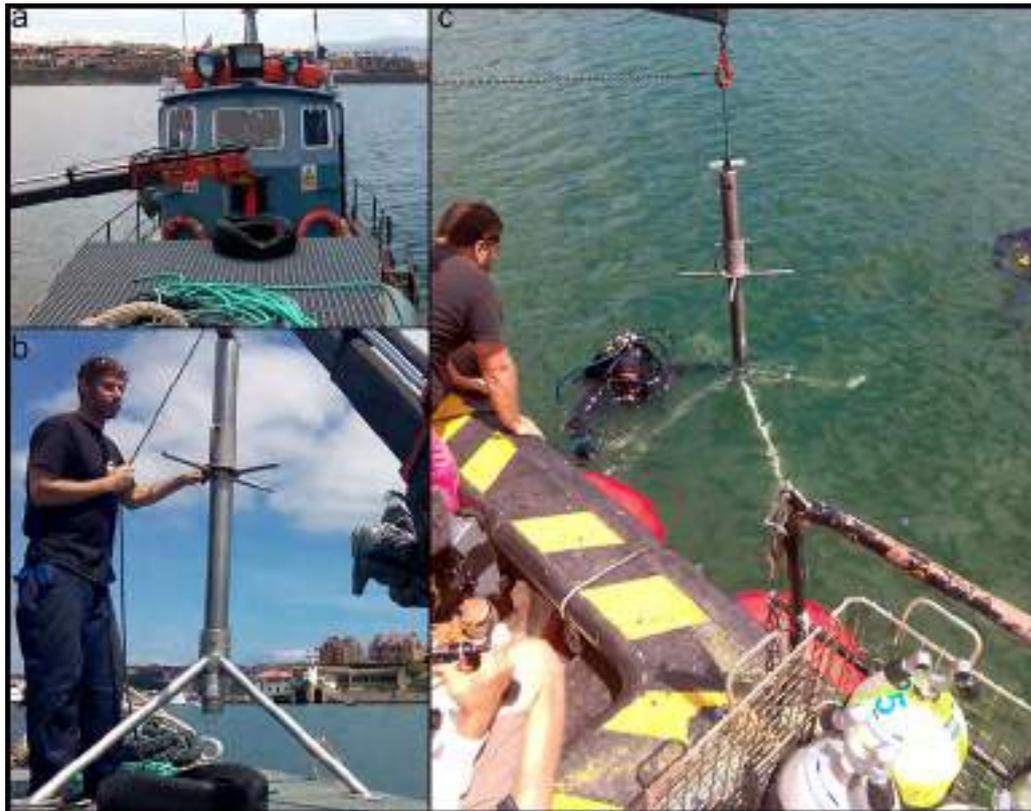
**Figura 2.5.** Proceso de extracción de los sondeos submareales en la zona interior del Abra de Bilbao (Bizkaia). a) Detalle de la embarcación y la grúa que transportó el sondeador. b) Montaje y aseguramiento del sondeador Hammer Corer. c) Operaciones de inmersión del sondeador para la perforación del lecho marino.
