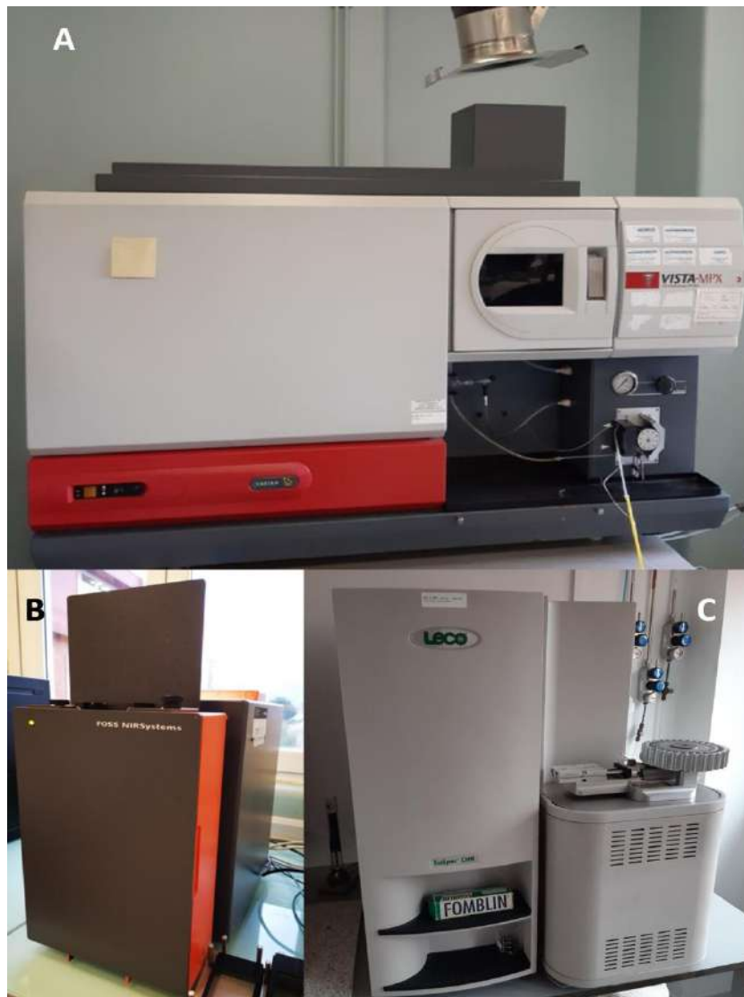
Figura 3.6. A, espectrofotómetro de emisión óptica por plasma acoplado inductivamente (ICP-OES); B, espectrofotómetro NIR; C, analizador elemental LECO CHN. Fuente: NEIKER.
