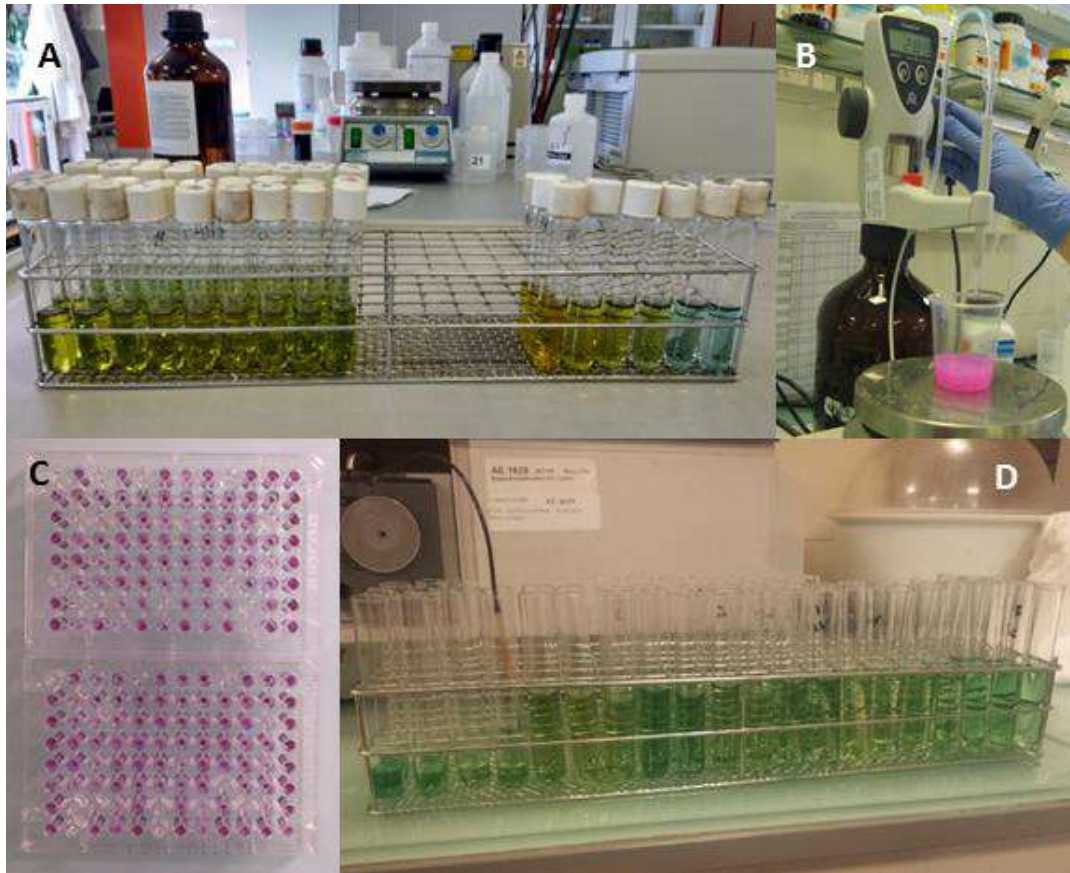
Figura 3.11. A, Determinación colorimétrica de carbono de la biomasa; B, valoración de NaOH en la determinación de la respiración del suelo; C, placas Biolog EcoPlates™; D, determinación colorimétrica de actividades enzimáticas. Fuente: NEIKER.
