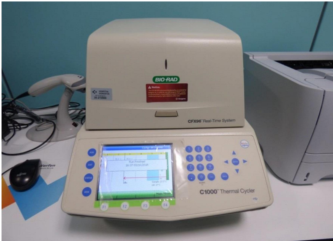
Figura 32. Termociclador CFX96 (BioRad) empleado en pruebas de PCR en tiempo real multiplex.
