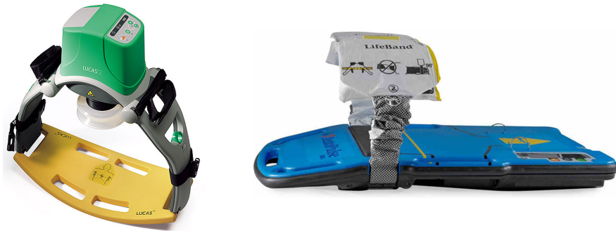
1.6. Irudia. LUCAS-2 eta AutoPulse gailuak. LUCAS-2 gailuak neumatikoki eragindako pistoi bat erabiltzen du pazientearen bularra konprimitzeko; AutoPulse gailuak, aldiz, bularraren inguruan kokatutako kargaren banaketa uniformerako banda bat erabiltzen du sakadak emateko.
