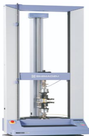
35. irudia Erresistentzia mekanikoa probatzeko ekipamendua (BCMaterials).
