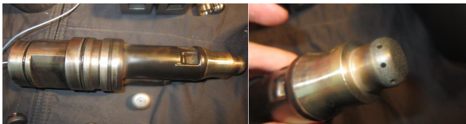
Figura 44. Precámara Siemens OPC (izda) y detalle de las toberas de salida (dcha).
