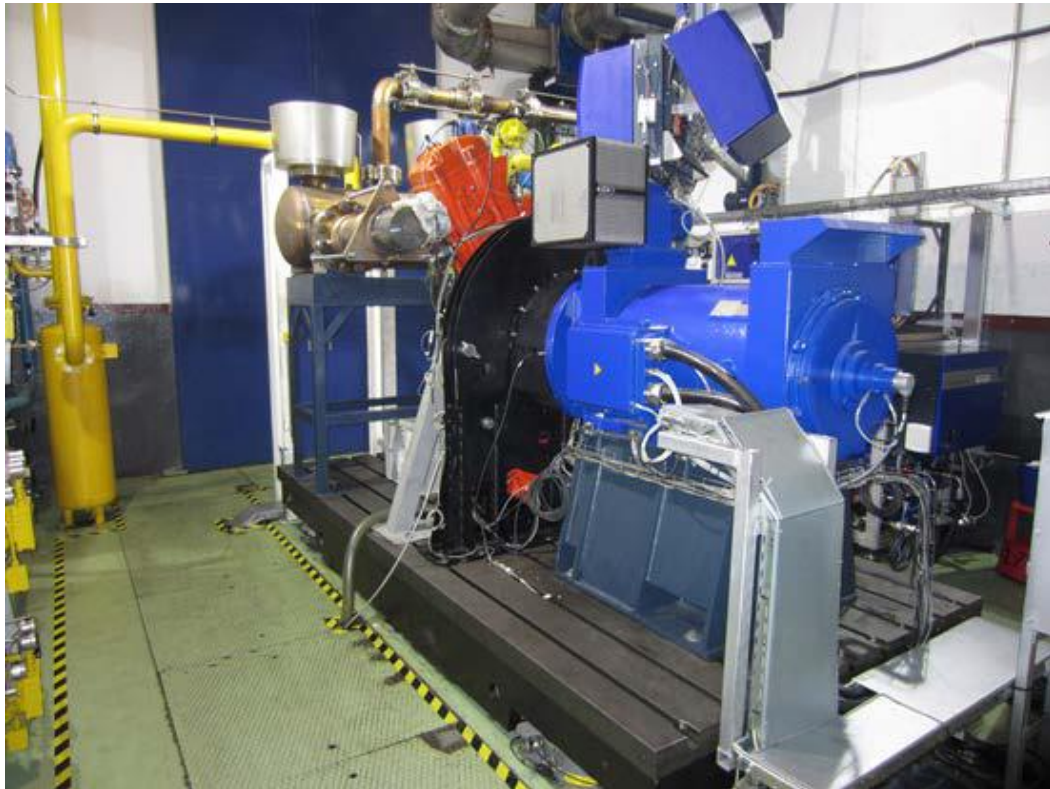
Figura 43. Motor SCE utilizado para la experimentación de la tesis doctoral.
