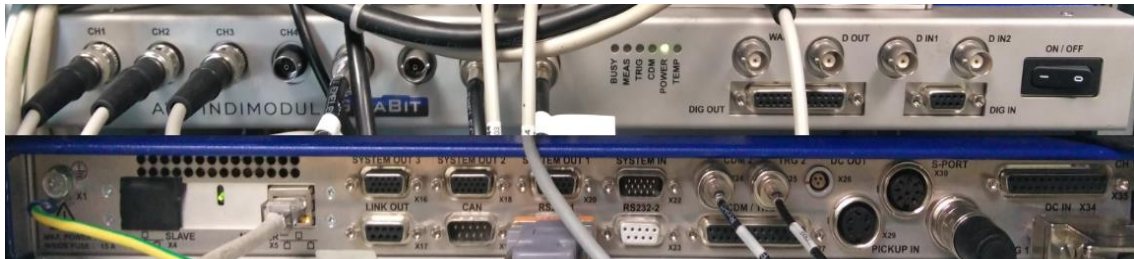
Figura 64. Imagen delantera (arriba) y trasera (abajo) del módulo Indimaster .
