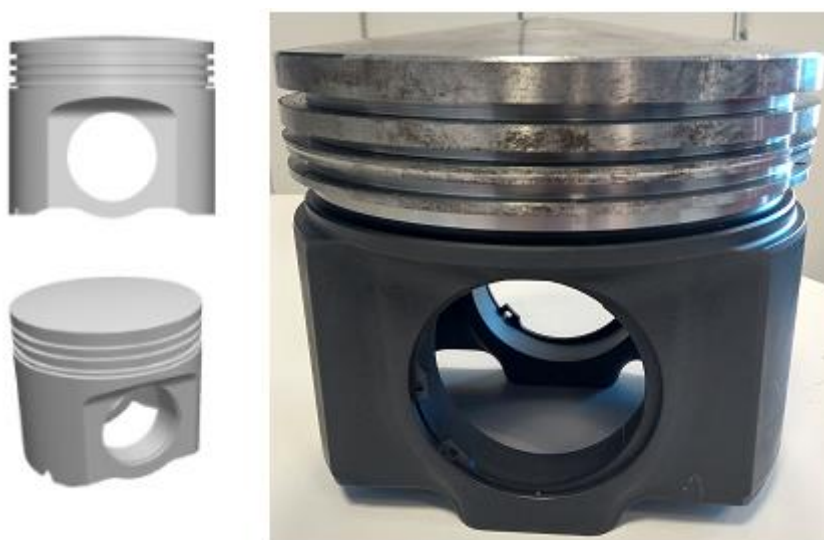
Figura 46. Diseño 3D (izda) y fotografía (dcha) de pistón Siemens OP.
