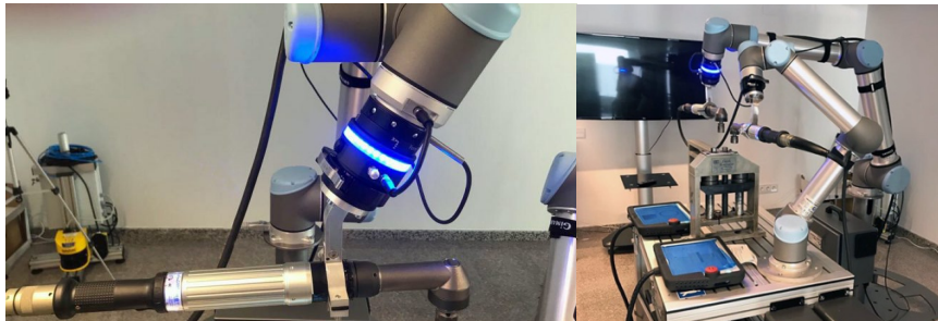
Irudia 28 UR-ko 140 Nm bihurtura prozesua {5}
