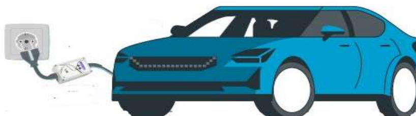
10.Irudia: Ibilgailu elektrikoa kargatzeko 2 modua
