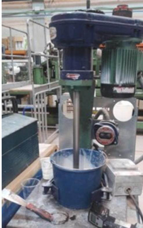
*Figura 3.2. Sistema de dispersión cowles de alto número de revoluciones*
