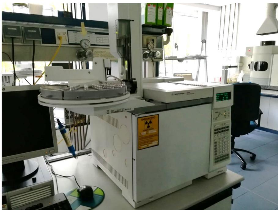
*Figura 3.15. Cromatógrafo de gases para la determinación del contenido en estireno de las resinas*
