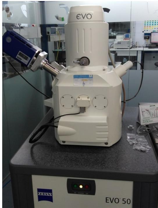
*Figura 3.18. Microscopio Electrónico de barrido (SEM) utilizado para evaluar la adherencia fibra-matriz y la porosidad en los laminados*
