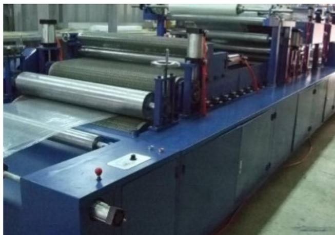
*Figura 2.19. Máquina para la fabricación de SMC*
