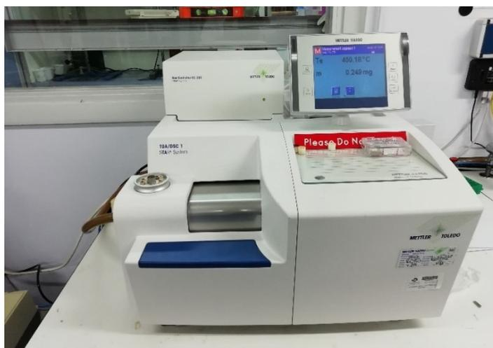
Figura 3.17. Equipo TGA utilizado para la caracterización de los SMC
