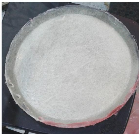
*Figura 3.7. Pieza desmoldeada de laminado*
