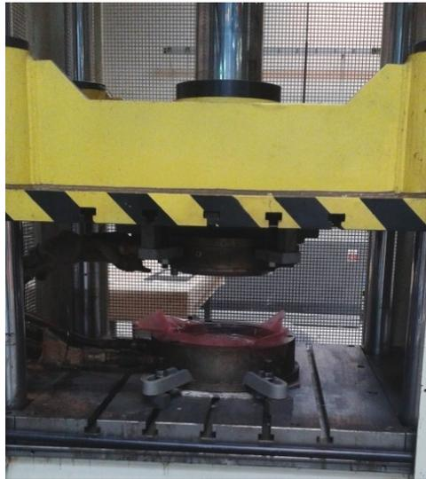
*Figura 3.6. Conformado de laminado manual en prensa hidráulica*
