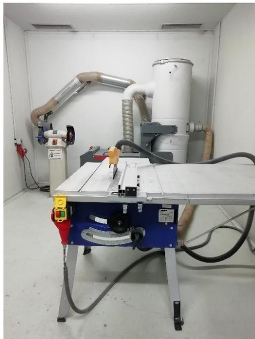
Figura 3.8. Sierra de bancada horizontal para el mecanizado de las probetas de SMC
