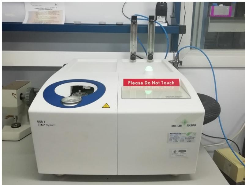
Figura 3.14. Equipo DSC para determinación de los calores y picos térmicos de las resinas
