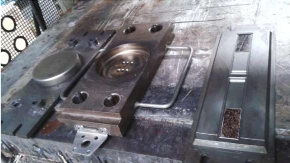
Figura 3.9. Molde para la fabricación de probetas de materiales híbridos acordes a la norma ASTM D429 Modelo B
