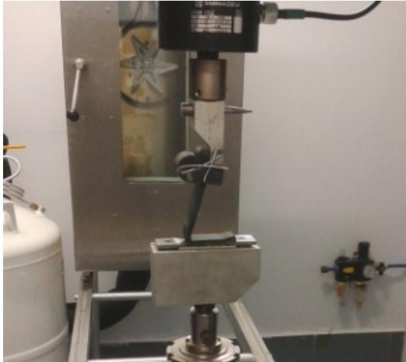
*Figura 3.20. Máquina universal para ensayo de los materiales híbridos en base a la norma ASTM D429 tipo B*
