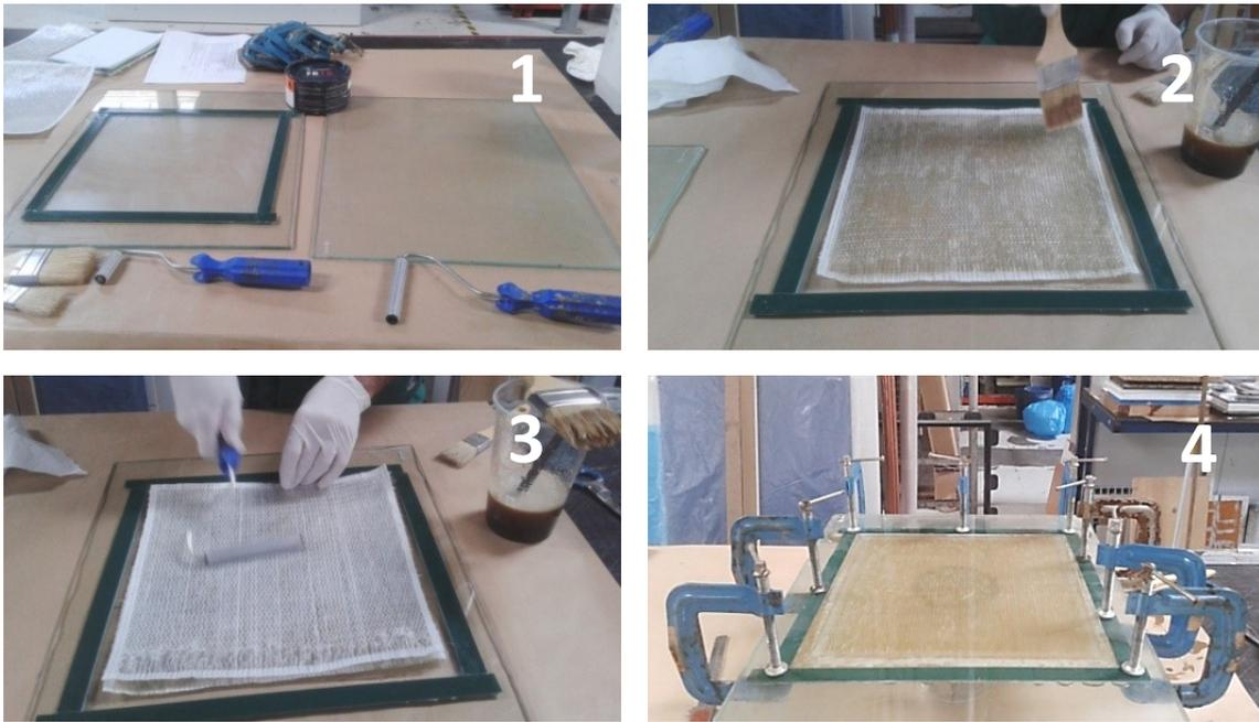
Figura 3.1. Proceso de fabricación del composite por laminación manual
