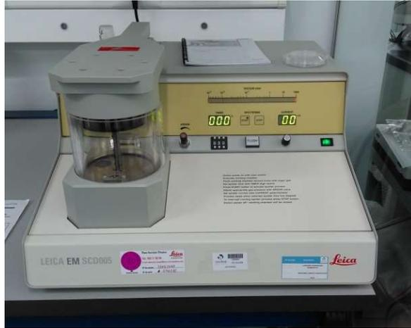
Figura 3.19. Equipo de Sputtering utilizado para el recubrimiento de las muestras a analizar por SEM
