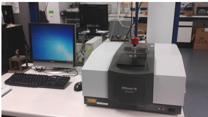
*Figura 3.12. Espectrofotómetro de infrarrojos (FTIR) utilizado para la caracterización de las resinas*
