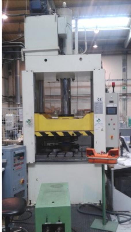
Figura 3.4. Prensa hidráulica utilizada para el moldeo del SMC
