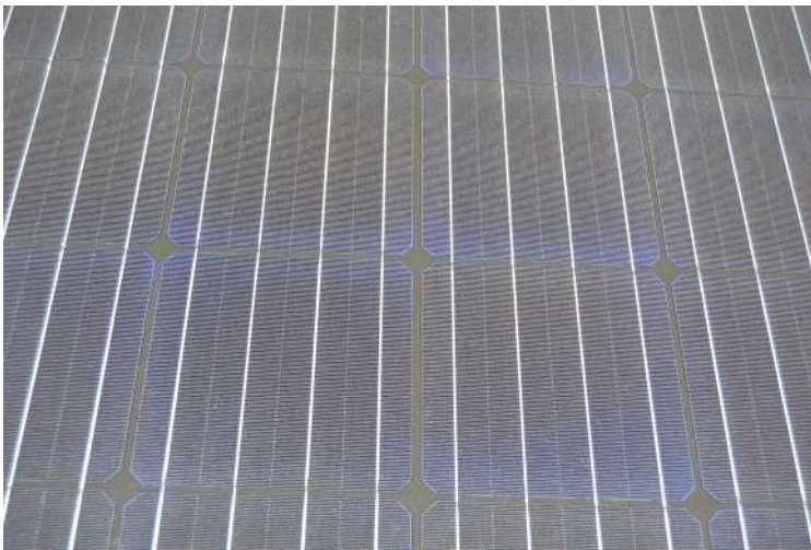
Figura 2.13. Decoloración del encapsulado en un módulo FV tras dos años de operación.
