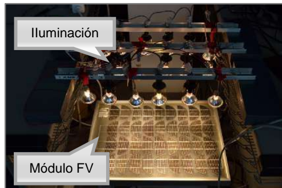
Figura 3.13. Sistema experimental montado. MC, CU, cargas electrónicas y fuente de corriente (arriba) y módulo FV e iluminación (abajo).
