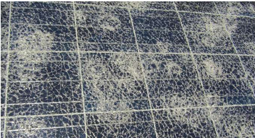
Figura 2.16. Módulo FV con rotura de cristal tras sufrir múltiples impactos severos por granizo en Austria. Extraído de Muehleisen et al. [117].
