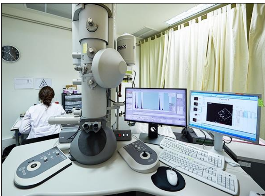
Figure 2.5. FEI Tecnai G2 F20 S-TWIN TEM (Thermofischer).
