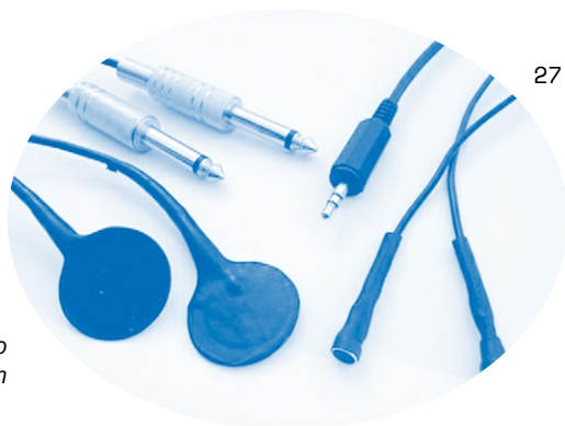
Figura 26. Micrófonos de contacto impermeabilizados con vinilo líquido.
