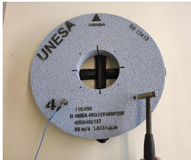
Figura 17. Posicionamiento del transductor y de la excitación para el modo fundamental de vibración.
