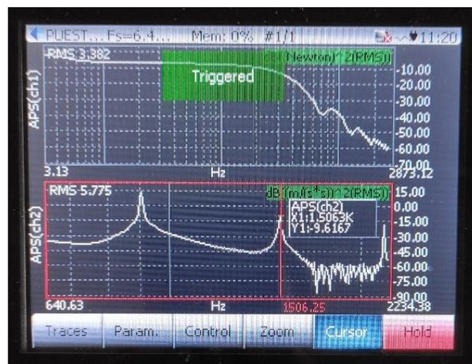
Figura 41. Valores de las dos primeras frecuencias naturales de la muela 3MBA 80H12V489P20P – 395 x 127 x 40.
