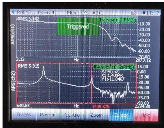
Figura 37. Valores de las dos primeras frecuencias naturales de la muela 3MBA 46G12V489P20P – 400 x 127 x 40.
