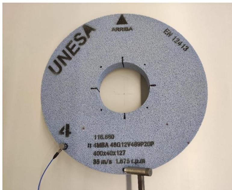
Figura 26. Configuración del análisis modal experimental con apoyos duros.
