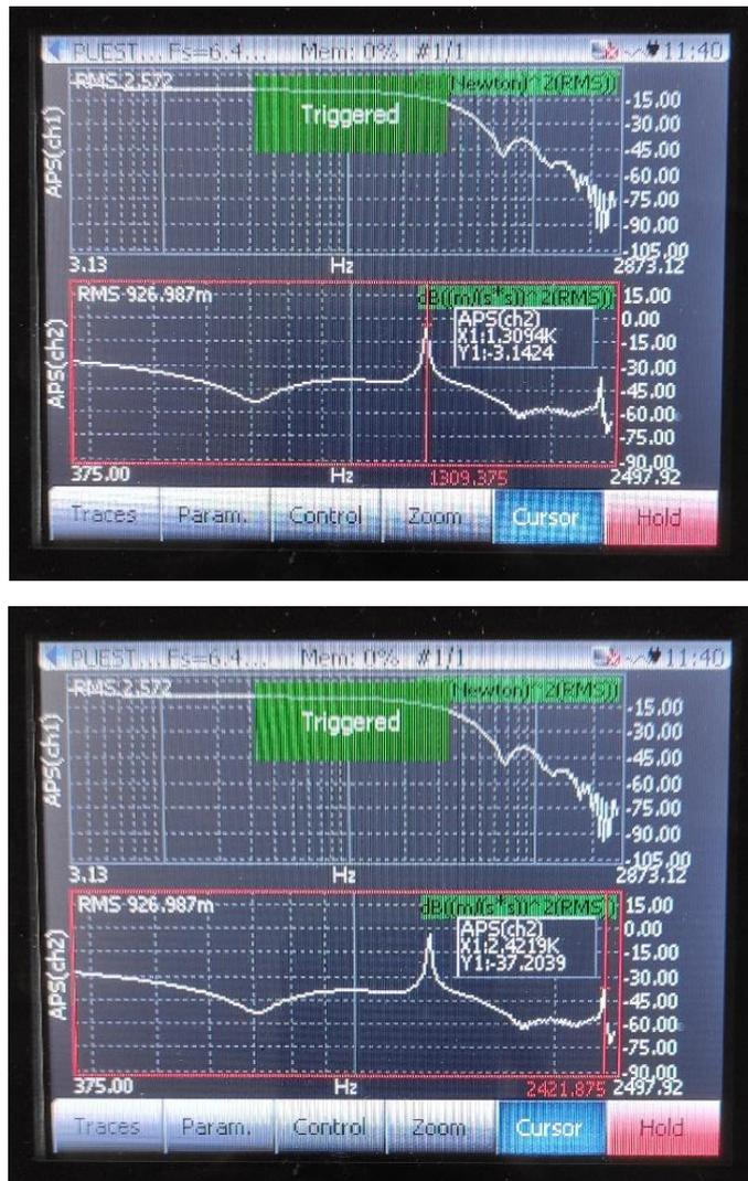
Figura 51. Valores de las dos primeras frecuencias naturales de la muela 5MBA 46G12V489P20P II – 300 x 127 x 40.
