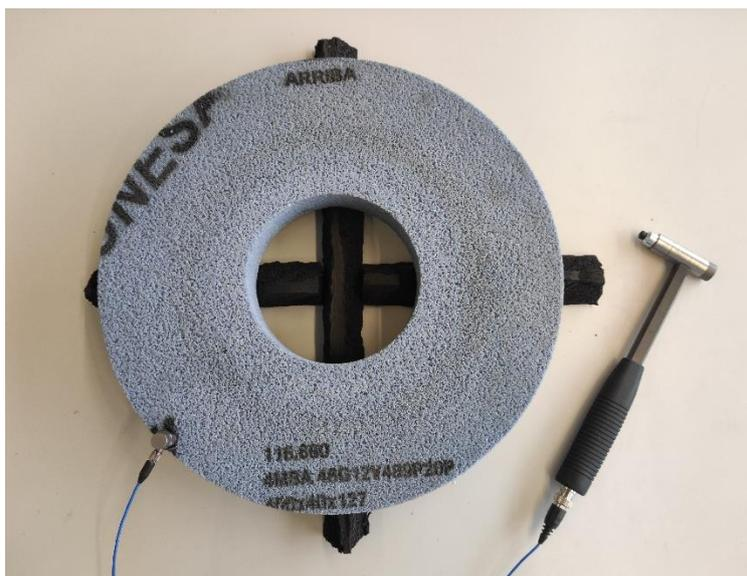
Figura 34. Configuración del análisis modal experimental para la muela 4MBA 46G12V489P20P – 343 x 127 x 40.
