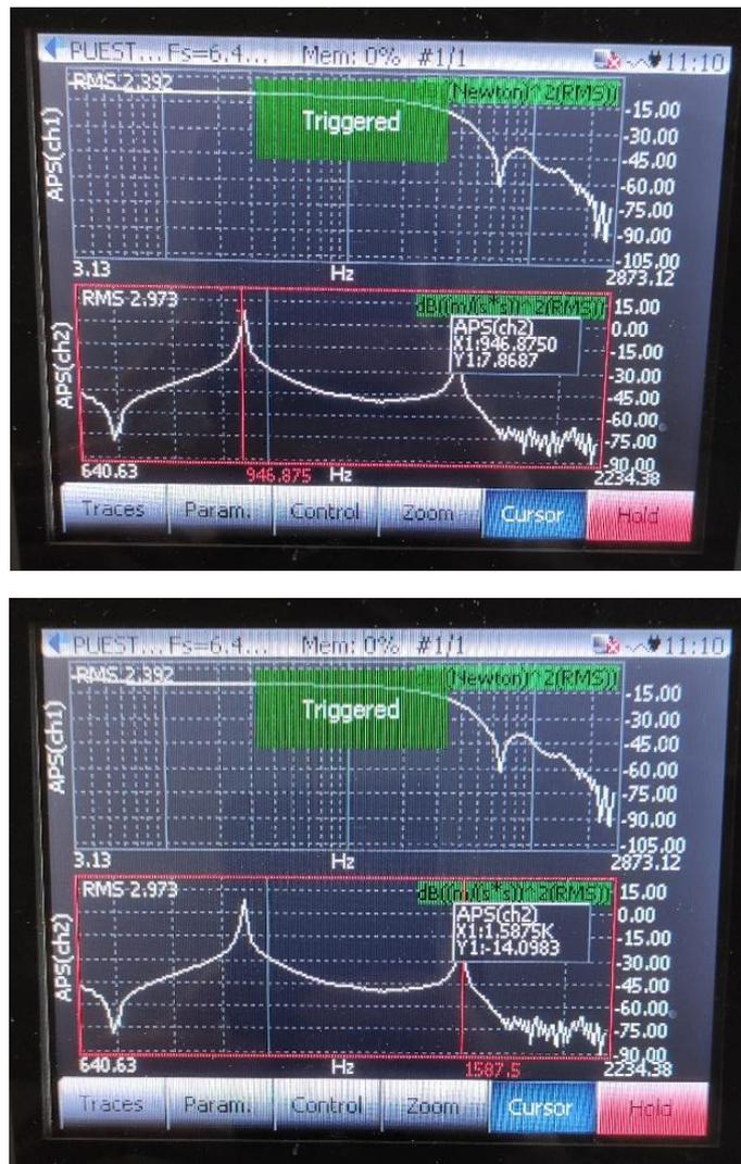
Figura 53. Valores de las dos primeras frecuencias naturales de la muela 3CXROBA 54R5V489 – 400 x 127 x 30.
