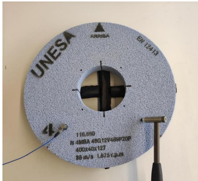
Figura 21. Configuración del análisis modal experimental con el 1º tipo de apoyo blando.
