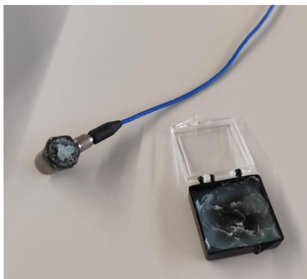
*Figura 16. Transductor piezoeléctrico y cera para su unión al sistema a medir.*
