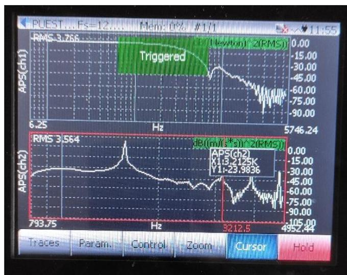
Figura 57. Valores de las dos primeras frecuencias naturales de la rueda MA 46EF12V489 I – 250 x 127 x 40.
