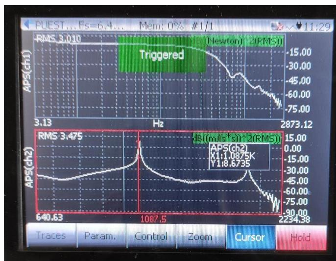
Figura 35. Valores de las dos primeras frecuencias naturales de la muela 4MBA 46G12V489P20P – 343 x 127 x 40.
