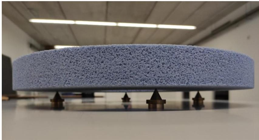
Figura 14. Contacto puntual entre los apoyos duros y la muela abrasiva.
