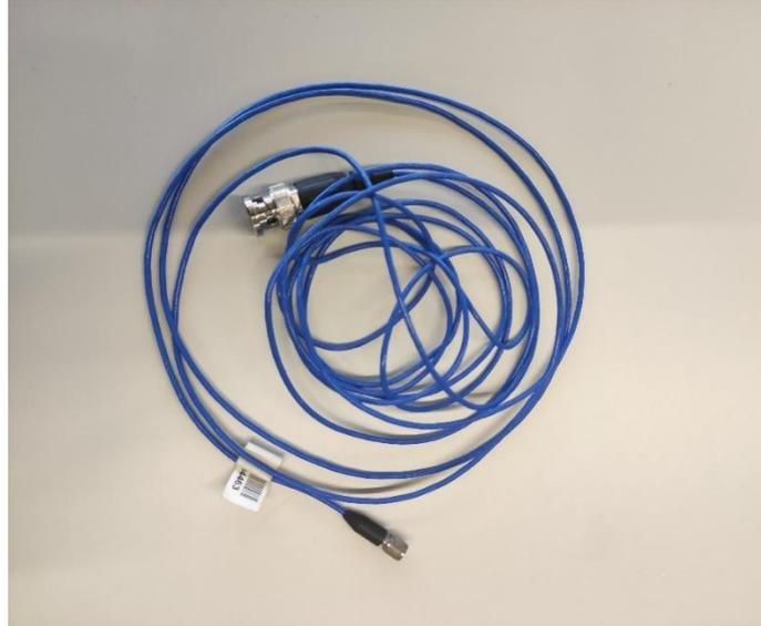
*Figura 19. Cables coaxiales aislados*
