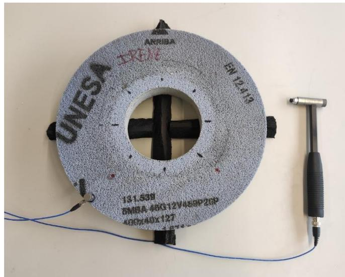
Figura 46. Configuración del análisis modal experimental para la muela 5MBA 46G12V489P20P – 350 x 127 x 40.
