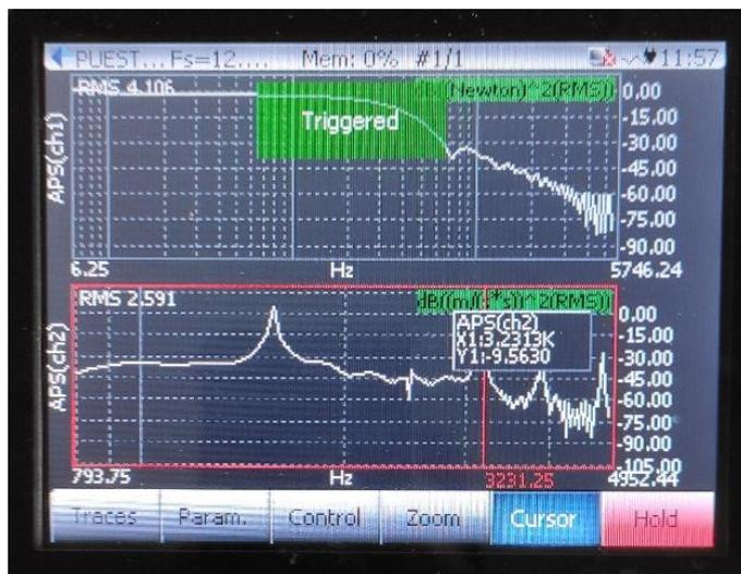
Figura 59. Valores de las dos primeras frecuencias naturales de la muela 5MBA 46G12V489P20P II – 300 x 127 x 40.
