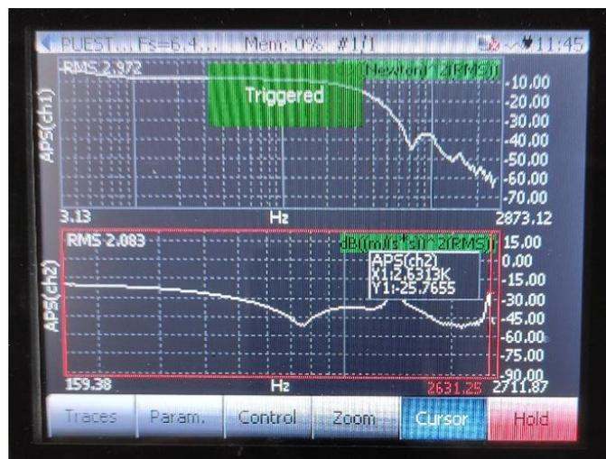
Figura 43. Valores de las dos primeras frecuencias naturales de la muela 3MBA 80H12V489P20P – 300 x 127 x 40.
