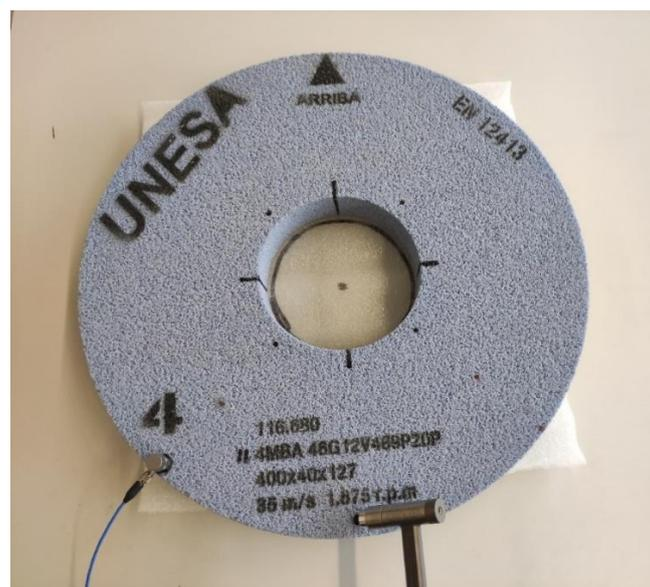
Figura 18. Posicionamiento del transductor y de la excitación para el segundo modo de vibración.
