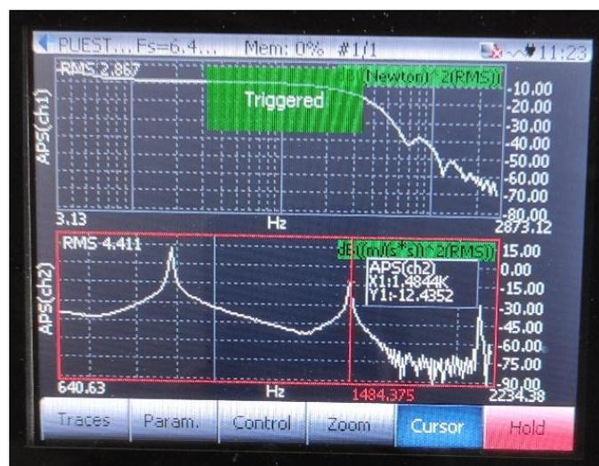
Figura 39. Valores de las dos primeras frecuencias naturales de la muela 3MBA 60H12V489P20P – 385 x 127 x 40.
