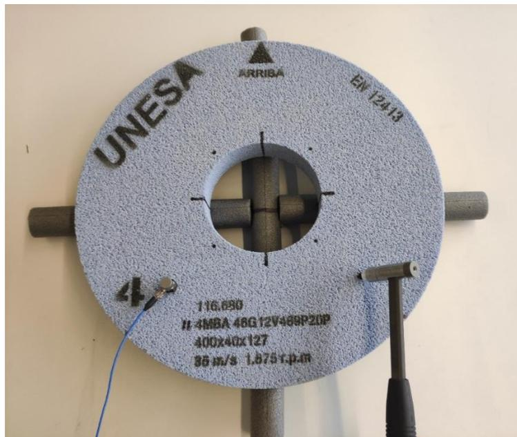
Figura 24. Configuración del análisis modal experimental con el 2º tipo de apoyo blando.
