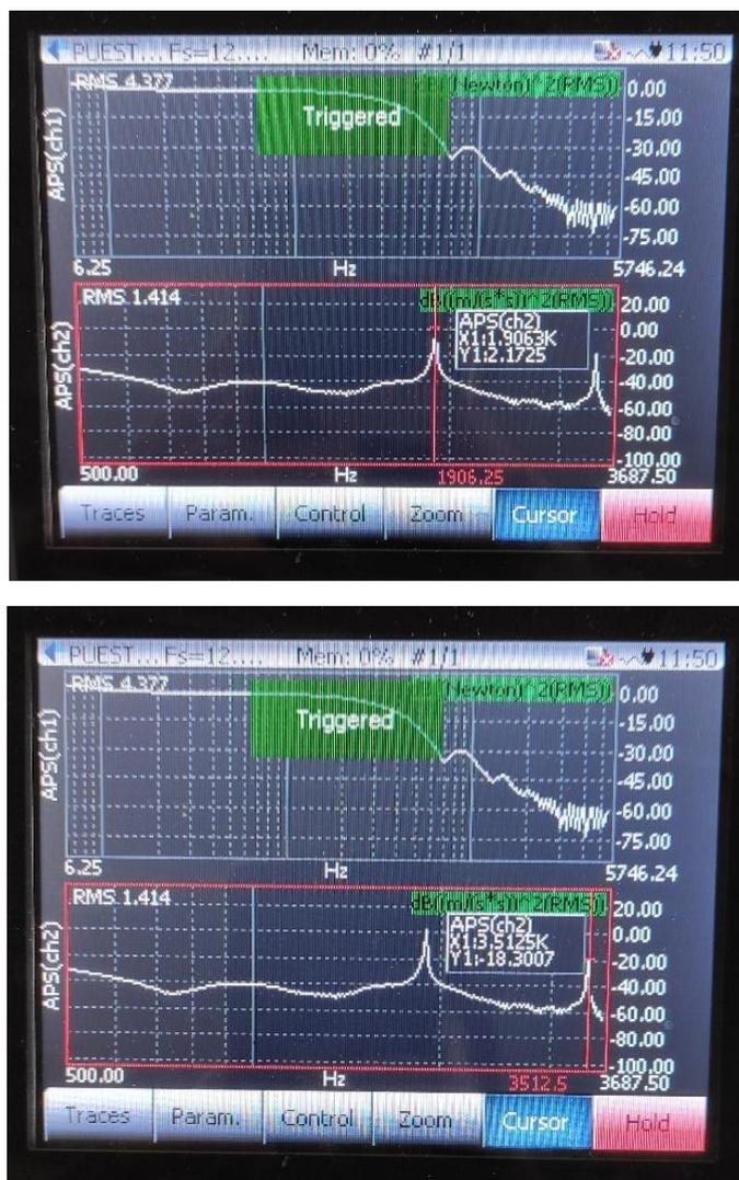
Figura 55. Valores de las dos primeras frecuencias naturales de la muela 3CXROBA 54R5V489 – 300 x 127 x 40.
