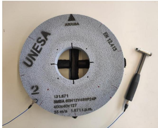
Figura 38. Configuración del análisis modal experimental para la muela 3MBA 60H12V489P20P – 385 x 127 x 40.
