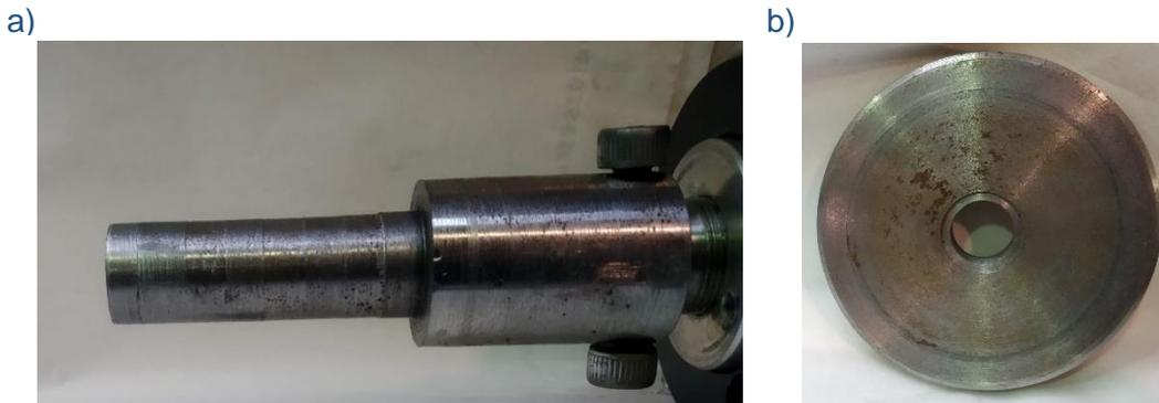
*Figura 6.11: a) Acoplamiento del eje motor. b) Platillo de seguridad.*
