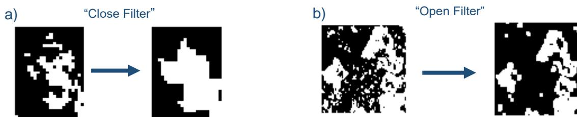
Figura 7.6: a) Efecto del "Close Filter". b) Efecto del "Open Filter"
