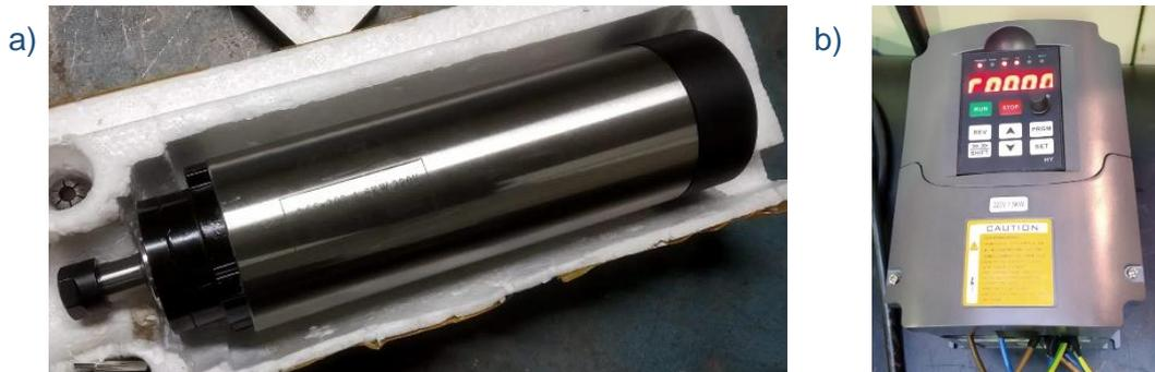
Figura 6.10: a) Motor 1,5 kW ER11 220V. b) Variador de frecuencia Huanyang
