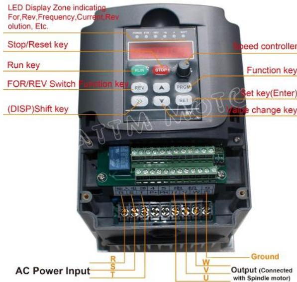
Figura 6.15: Conexiones del variador de frecuencia. Fuente: ebay.es
