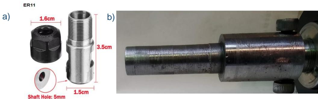
Figura 6.12: a) Eje del motor tipo ER11. b) Acoplamiento del eje motor
