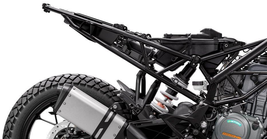
Figura 1-4 Semichasis tubular con triangulación
