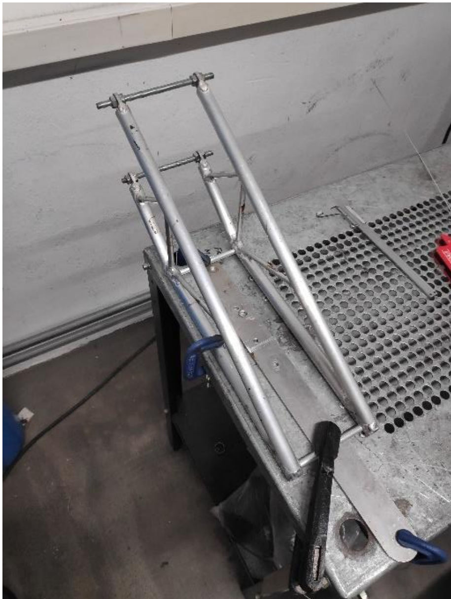
Figura 2-40 Posicionamiento de los montantes y rigidizadores
