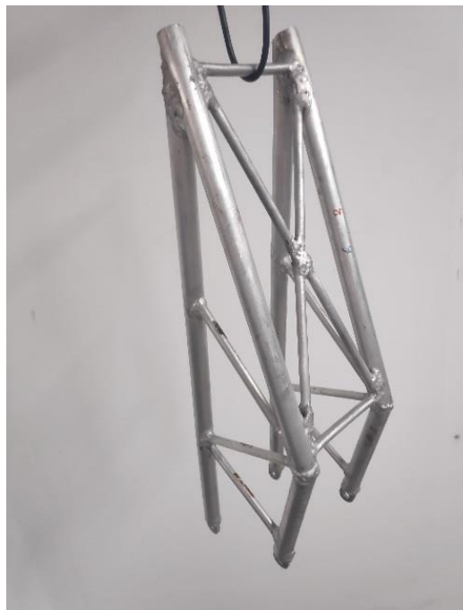
Figura 2-43 Ensayo de medida de las frecuencias naturales del chasis
