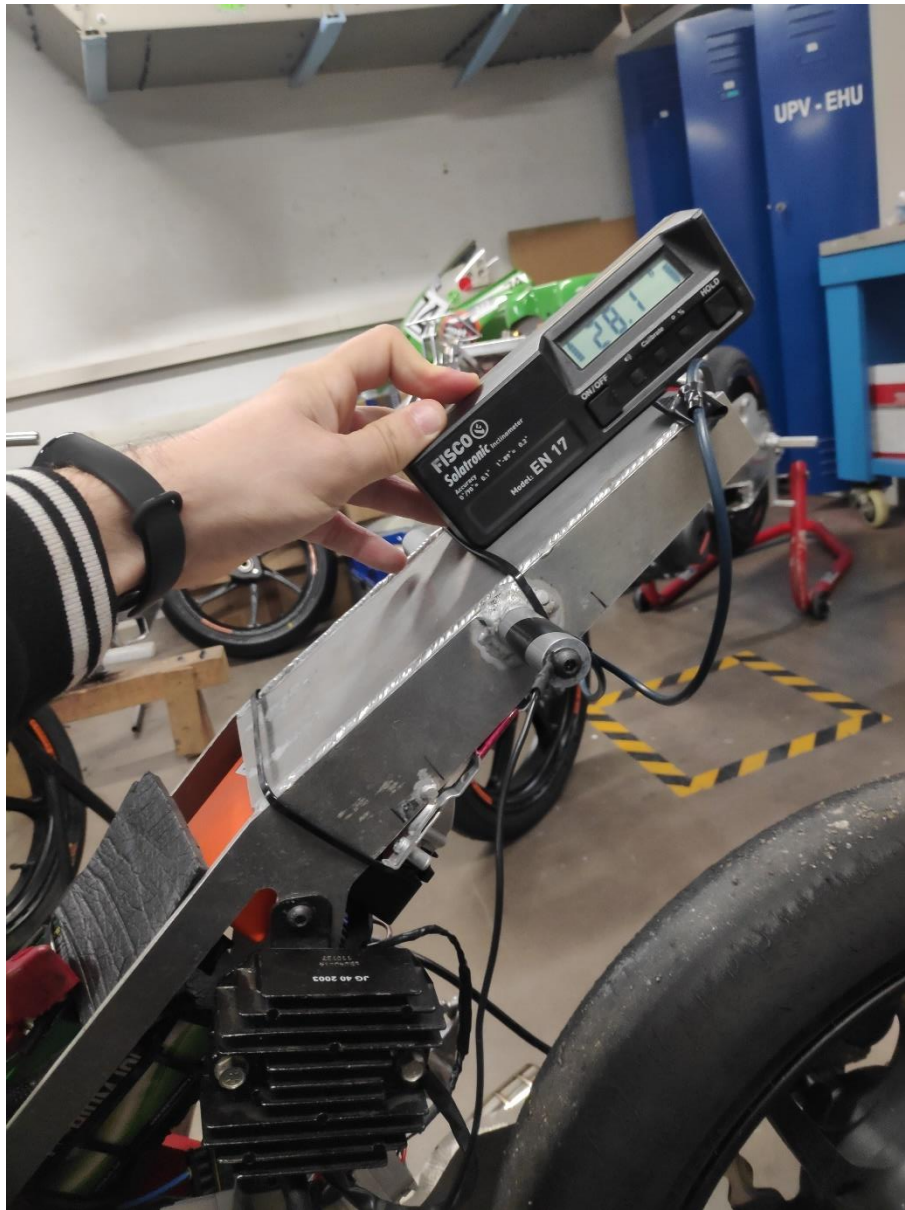
Figura 2-37 Comprobación del ángulo de inclinación del semichasis
