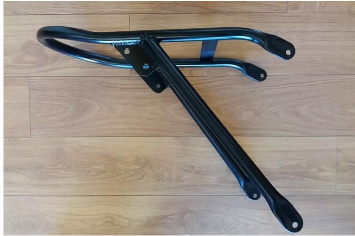
Figura 1-3 Semichasis tubular sin triangulación
