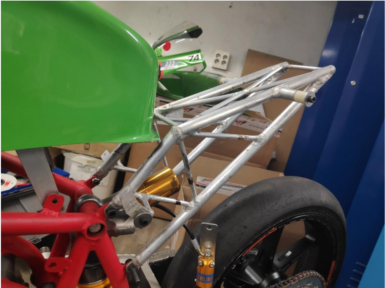
Figura 2-41 Semichasis terminado montado en la motocicleta
