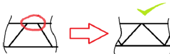
Ejemplo de triangulación correcta
