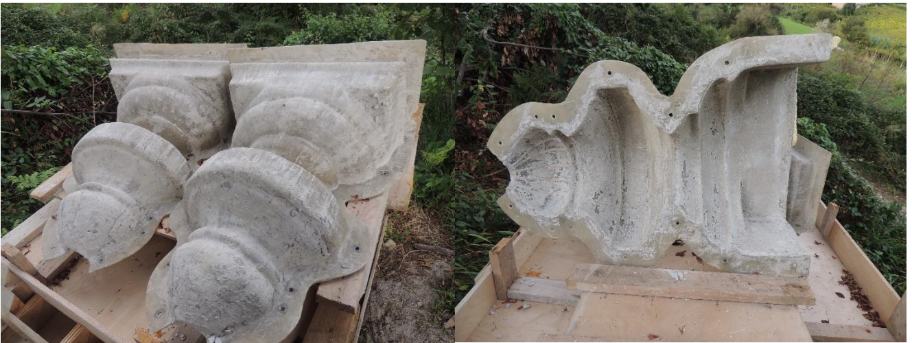
Figura 14. Molde de fibra de vidrio y resina de poliéster utilizado para la reposición de elementos en el Torreón de Zarautz.2019.
