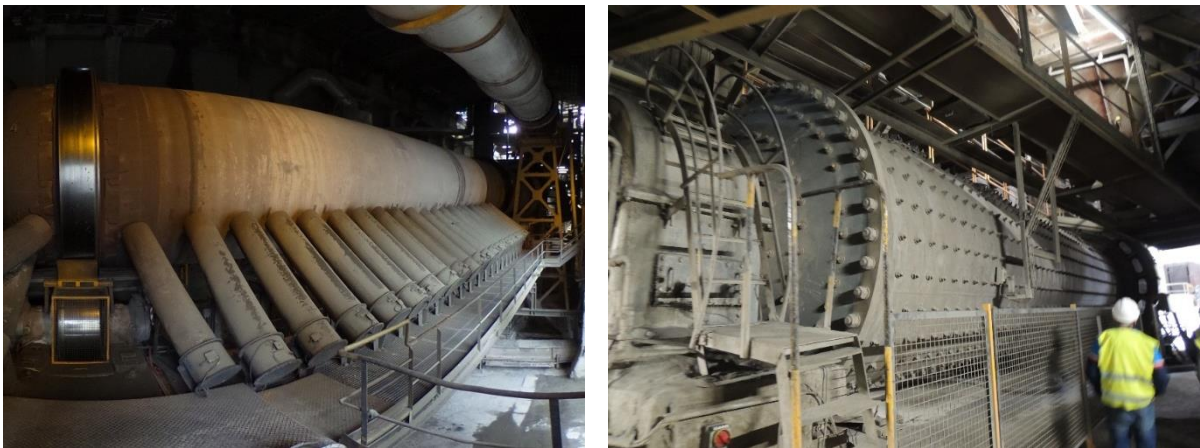
Figura 5. Horno rotatorio (izquierda) y molino de bolas (derecha) en la fábrica de Cementos Rezola. Donostia. 2019.
