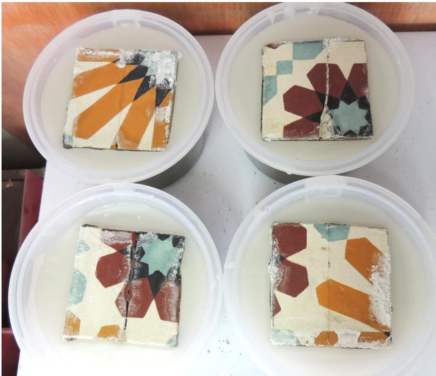
Figura 110. Probetas de encolado de mosaico hidráulico al 6 día del envejecimiento de sales por capilaridad. 2021.
