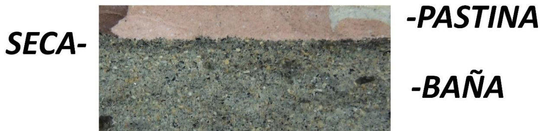
Figura 89. Esquema de las partes de una baldosa.
