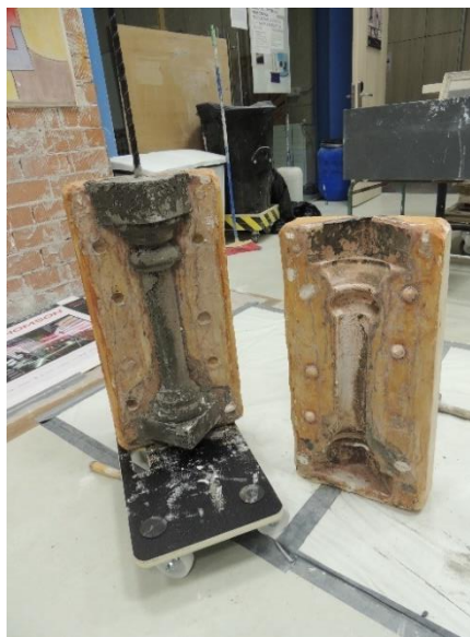
Figura 13. Fabricación de un balaustre con técnica tradicional II. Autoría propia con la colaboración de ACC Escultura. 2019.
