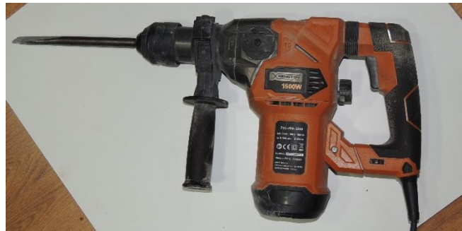
Figura 109. Eliminación de morteros con la ayuda de un taladro percutor. 2021.
