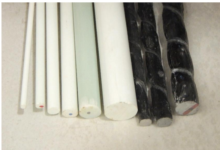
Figura 81. Modelos de barrillas de fibra de vidrio lisas y corrugadas. 2021.
