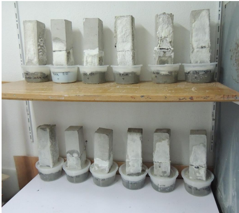
Figura 70. Ensayo de penetración de sales por capilaridad en el 15º día. En la parte superior se encuentran las probetas con armadura y en la inferior las sencillas.
