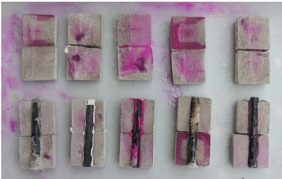
Figura 72. Ensayo de penetración de contaminantes.
