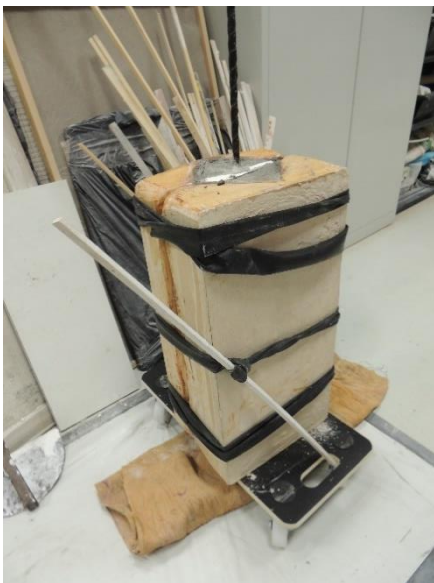
Figura 13. Fabricación de un balaustre con técnica tradicional II. Autoría propia con la colaboración de ACC Escultura. 2019.
