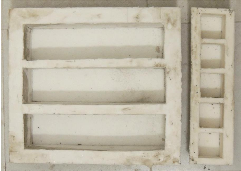
Figura 19. Distintos moldes utilizados para la realización de probetas.
