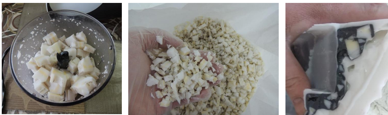
Figura 80. Inclusión de fragmentos de silicona para permitir la mayor adaptación del molde. 2021.
