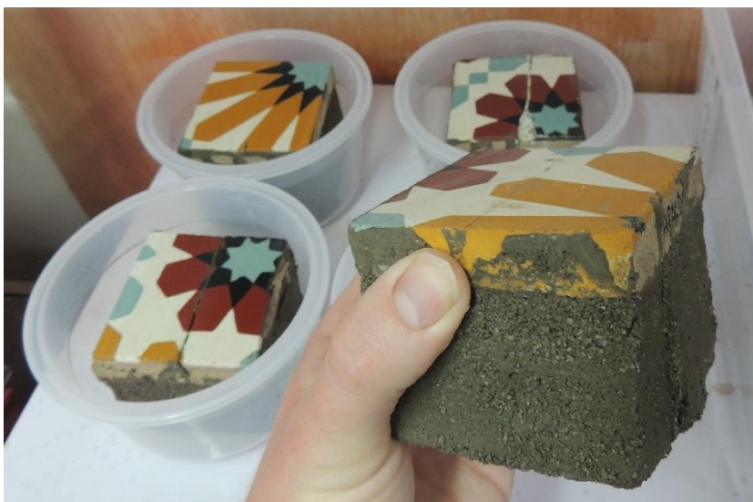
Figura 24. Probeta de mosaico preparada para el ensayo de sales por capilaridad.
