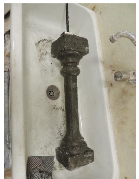
Figura 13. Fabricación de un balaustre con técnica tradicional II. Autoría propia con la colaboración de ACC Escultura. 2019.
