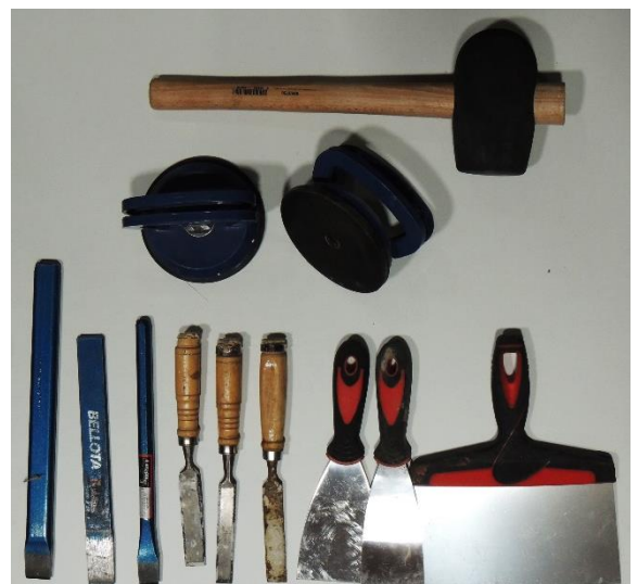
Figura 105. Distintas herramientas utilizadas para la extracción de piezas.
