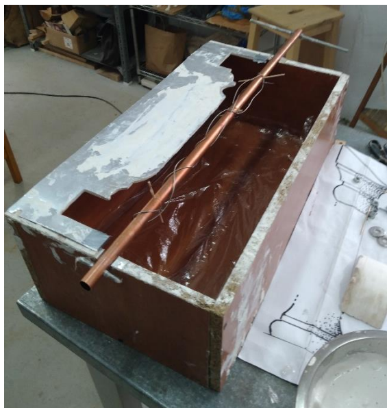
Figura 12. Fabricación de un balaustre con técnica tradicional I. Autoría propia con la colaboración de ACC Escultura. 2019.
