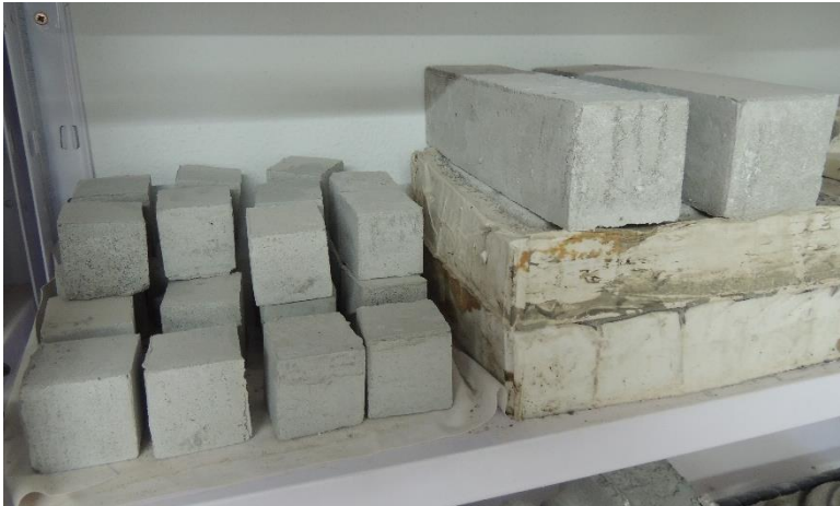
Figura 21. Distintas probetas durante en proceso de endurecimiento
