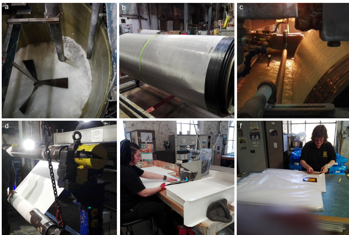
Figura 45. Proceso de trabajo en el molino papelerero de StCuthberts Mill en Somerset, Reino Unido: a) Preparación de la pasta papelerera; b) Malla cilíndrica empleada para la formación del papel; c) Proceso de formación de la hoja; d) Enrollado del papel en bobinas; e) Corte manual de las hojas y estampado del sello en seco; f) Embolsado y etiquetado de los papeles para su distribución
