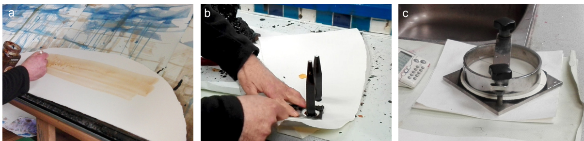
Figura 41. Diferentes tipos de ensayo realizados para asegurar la calidad del papel durante la producción: (a) imprimibilidad; (b) ceras de Dennison; (c) Cobb
