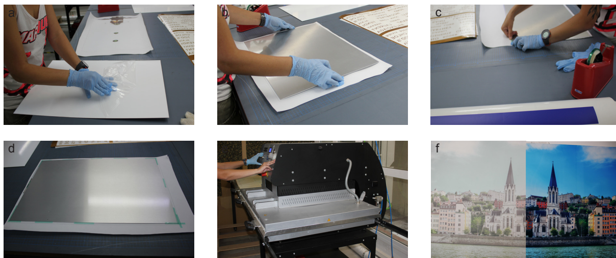
Figura 36. Proceso de impresión termográfica de sublimación de tintes. a) Eliminación de la película protectora de la superficie del soporte definitivo; b) Colocación cara a cara del soporte definitivo sobre el soporte temporal impreso; c) sujeción de ambos soportes con cinta adhesiva resistente a altas temperaturas; d) Sándwich resultante de la unión de ambos soportes; e) Prensa de calor ejerciendo presión para la correcta transferencia de las tintas; f) soporte temporal con restos de la tinta que no se ha transferido (izquierda) y resultado final de la impresión (derecha)
