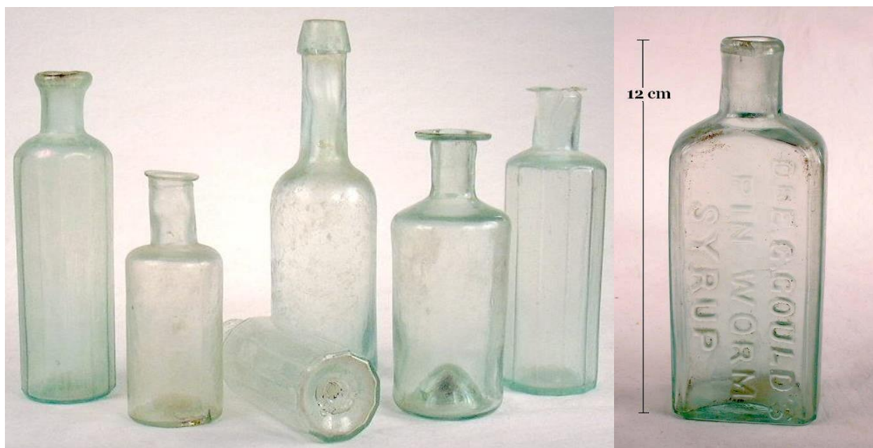
Figura 187. A mano izquierda, variedad de botellas de tipo utilitario. Todas elaboradas en moldes de dos piezas (moldes de bisagra), salvo la segunda empezando por la derecha, posiblemente bajo soplado a mano o moldeado por inmersión. Presentan varios acabados, de los cuales llama la atención como tres de ellos presentan 12 caras en el cuerpo, formando un dodecágono, una configuración común para estos primeros frascos medicinales; Figura 188. A mano derecha, tenemos un ejemplo de un medicamento patentado de mediados del siglo XIX, rectangular y con relieve. Se lee DR. E. G. GOULD'S / PIN WORM / SYRUP (Jarabe de gusano del doctor E. G. Gould), de 1865/1870 ( https://sha.org/bottle/medicinal.htm#Early%20Medicinal%20Bottles )
