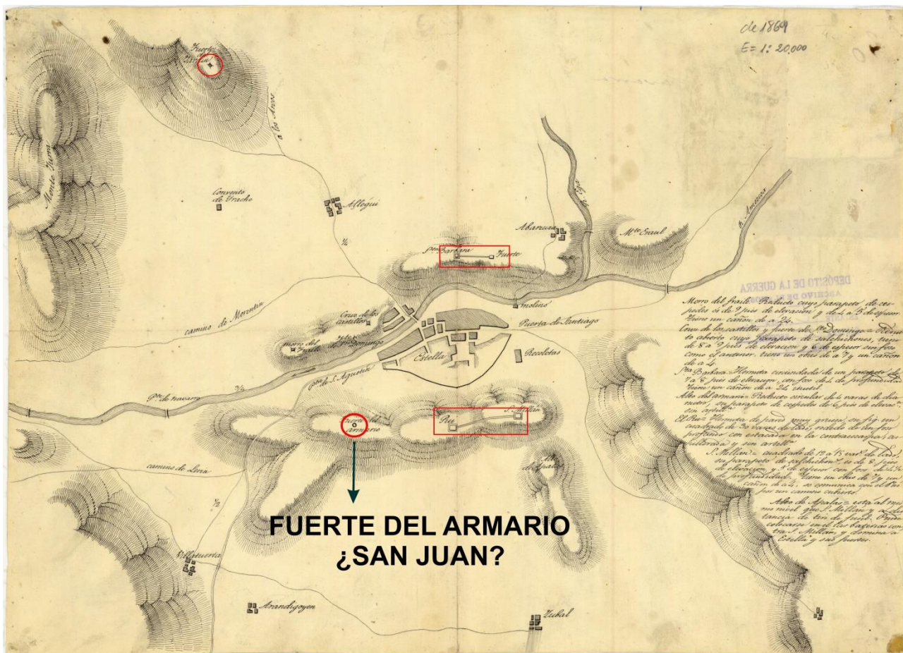
Figura 99. Se lee en el mapa: fuerte del Armario: reducto circular de cuatro varas de diámetro, su parapeto de céspedes de seis pies de elevación. Sin artillería (Depósito de la Guerra)
