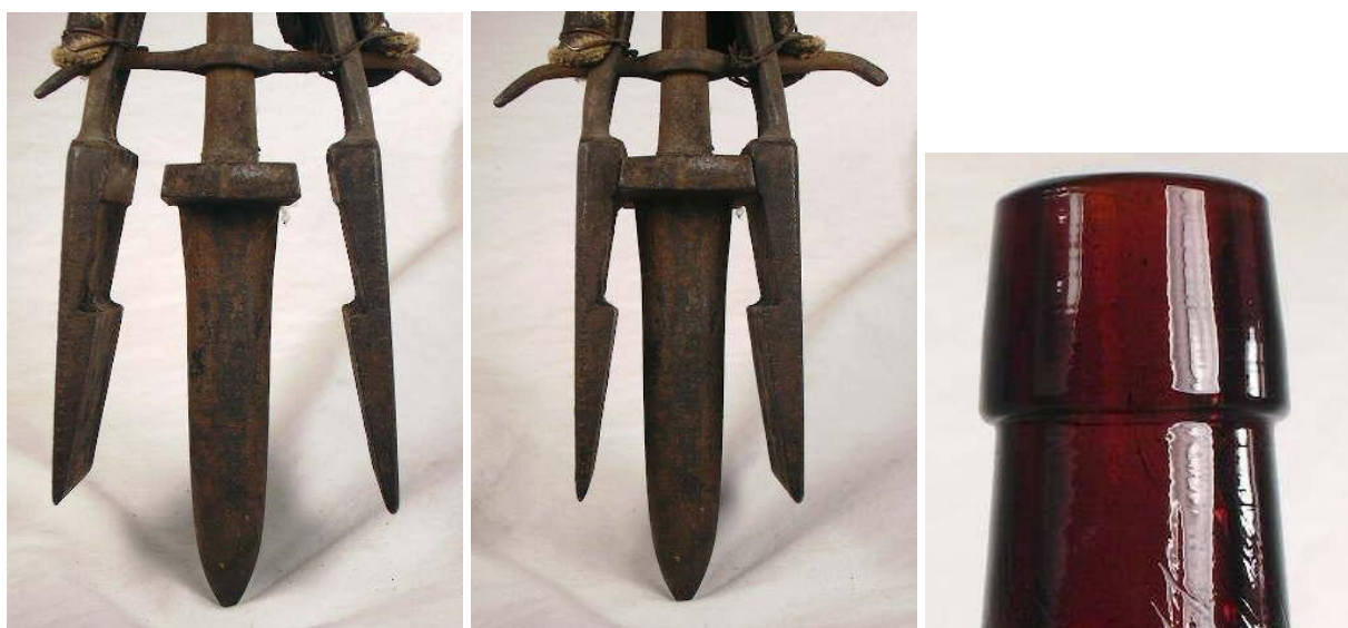
Figura 175. La imagen de la izquierda muestra las mordazas y el eje central de la herramienta de acabado, con las mordazas abiertas para insertar en él el orificio de la botella que va a ser terminada. La imagen del medio muestra la herramienta con las mordazas cerradas. Tras esto, simplemente habría que hacer girar las mordazas para dar forma a la boca de la botella. Finalmente, en la imagen de la derecha, mostramos un acabado parecido al que se hubiera obtenido de esta herramienta 115
