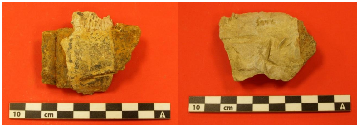
Figura 244. Fragmento de envuelta de granada con el año 1870 de producción marcado en el cuello (ABZ4.18.0103); Figura 245. Fragmento de envuelta de granada con el año 1874 de producción marcado en el cuello (ABZ4.18.0021)
