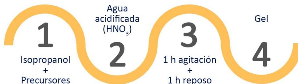
*Figura 2.2. Esquema de la síntesis de los recubrimientos.*
