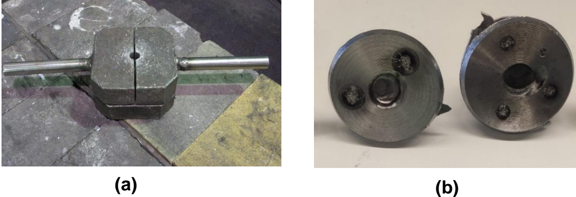
Figura 18. (a) Molde y (b) muestra para la determinación de la composición elemental de las aleaciones investigadas
