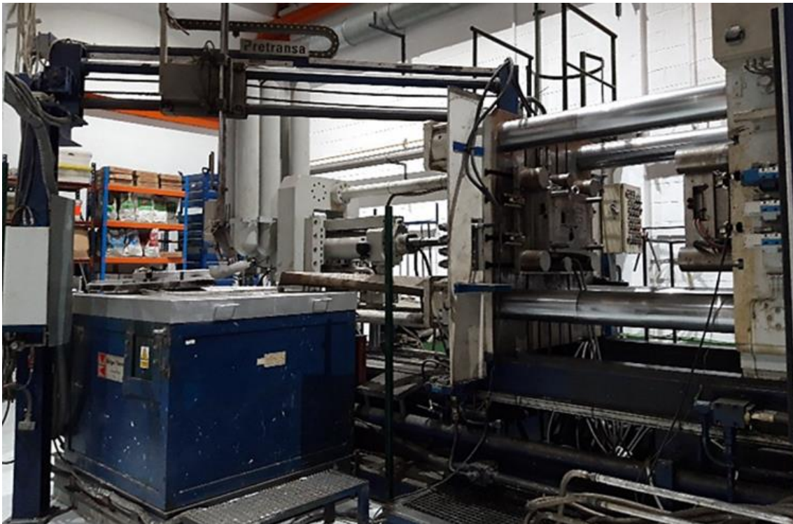
Figura 16. Horno de resistencias eléctricas y célula de inyección empleada
