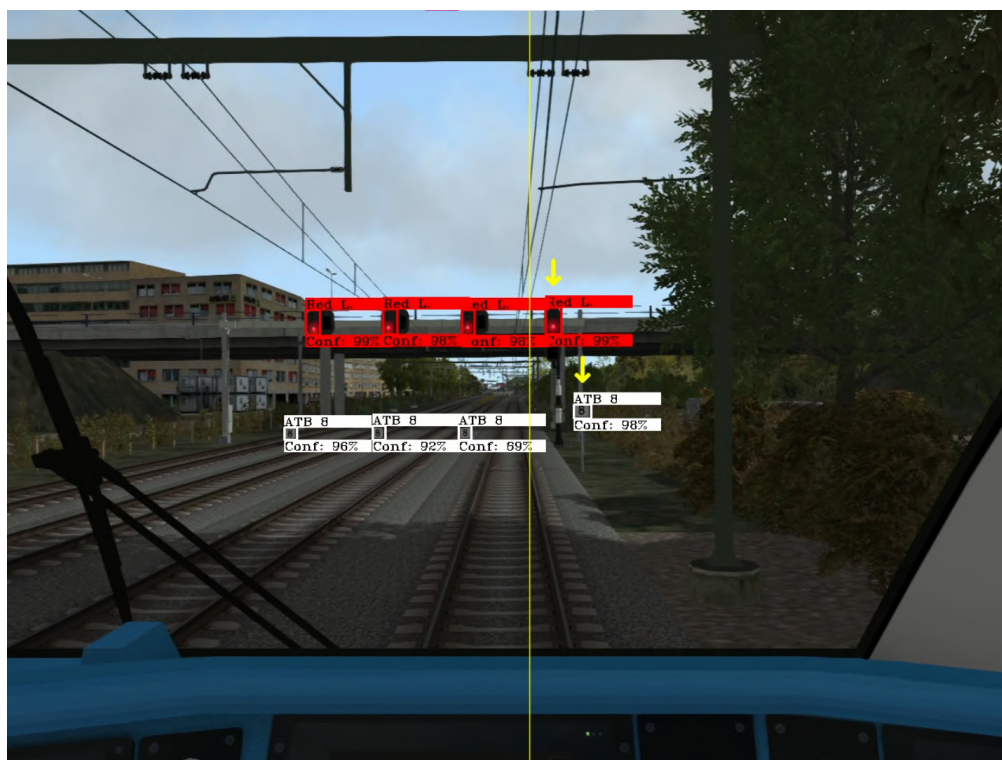
6.12 Irudia: Eredutik igarotako frame bat. Semaforo gorrien eta abiadura panelen detekzioa.
