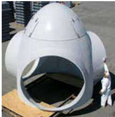
23.Irudia. Bujea eta Bujearen kutxa . Buje de aerogenerador. (2014, otsailak 16). Fuentes de Energía. https://triple97.wordpress.com/energia-eolica/aerogeneradores/partes-de-un-aerogenerador/rotor/buje-de-aerogenerador-tik-berreskuratua
