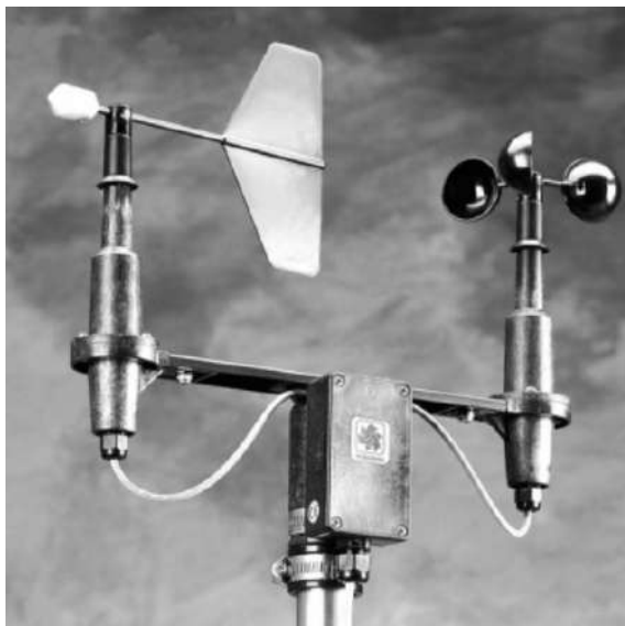
31.Irudia. Beleta eta anemometroa. Anemómetro-veleta Wind Sentry. (n.d.). Grupo EIC Iberia. Ekainaren 16, 2021, https://eiccontrols.com/es/inicio/336-eic-03002-anemometro-veleta-wind-sentry.html -tik aterata
