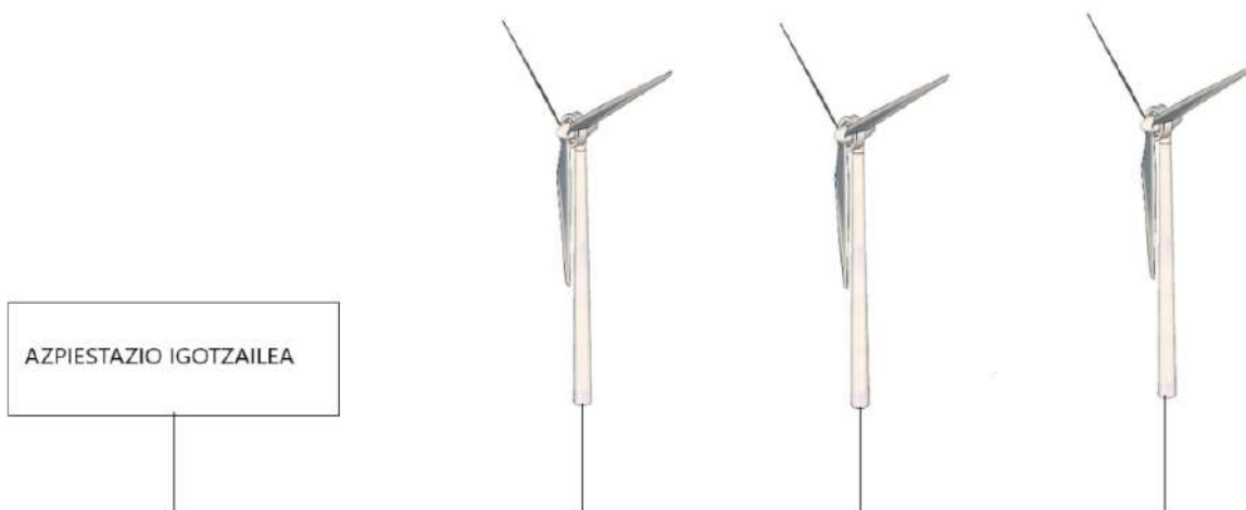
53.Irudia. Aerosorgailuen lur azpiko linea eta azpiestazio igotzailera konexioa
