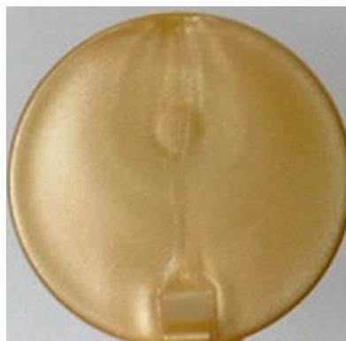
Figura 20 : Línea de soldadura
