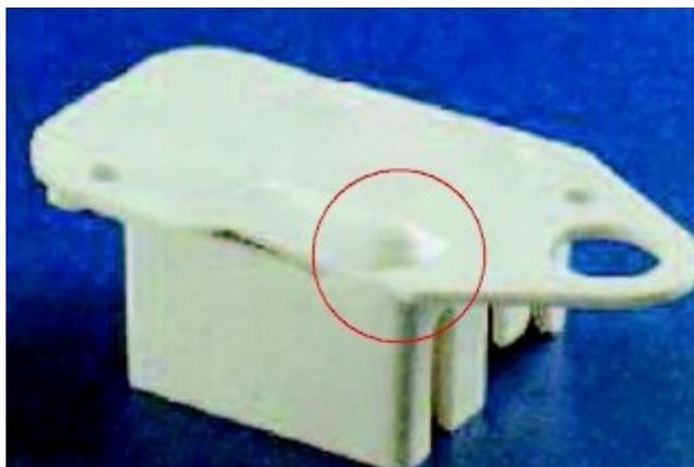
Figura 32 : Deformación de la expulsión
