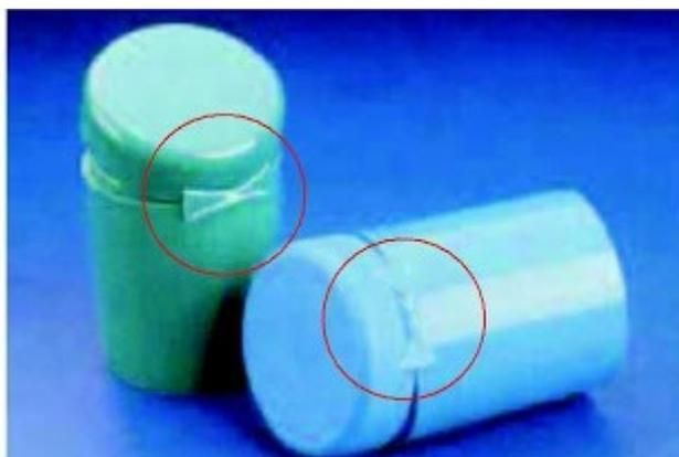
Figura 29 : Tensiones en bisagras
