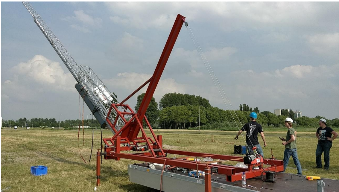
Figura 11. Plataforma de lanzamiento construida por el equipo Dare.
