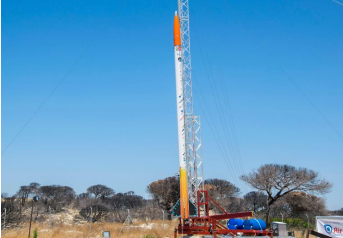
Figura 12. Plataforma de lanzamiento construida por el equipo Delft.
