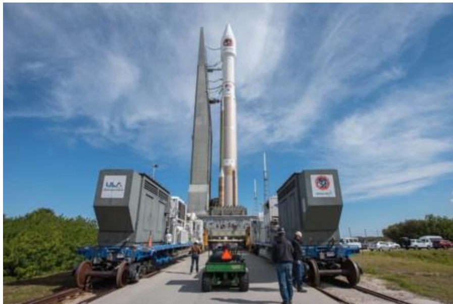
Figura 10. Sistema de transporte para cohetes ensamblados verticalmente.
