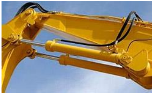
Figura 19. Vista de los pistones hidráulicos utilizados en una excavadora.
