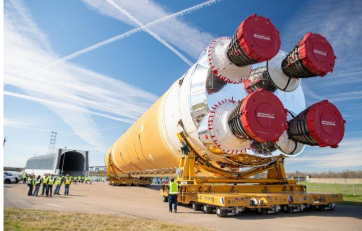
Figura 9. Sistema de transporte de cohetes integrados horizontalmente.
