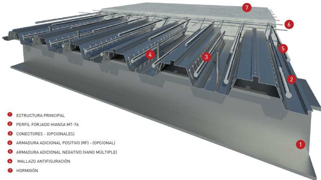
Ilustración 90. Detalles del forjado colaborante MT-76.
