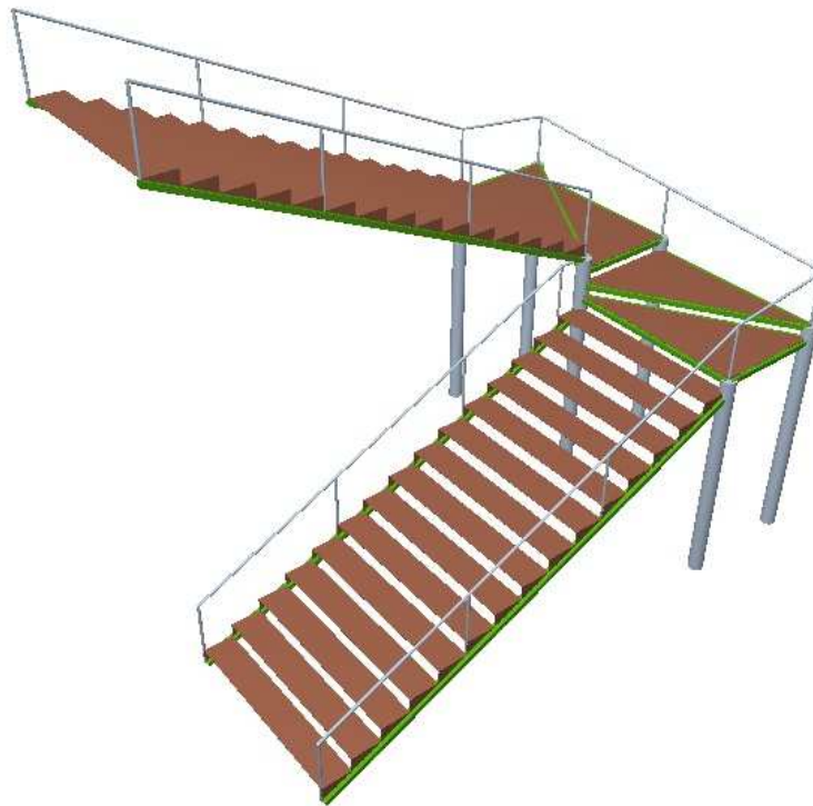
Ilustración 94. Escalera de acceso a la entreplanta.
