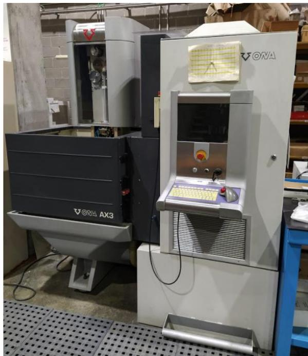
Figura 85. Máquina de electroerosión de ONA, modelo AX3.
