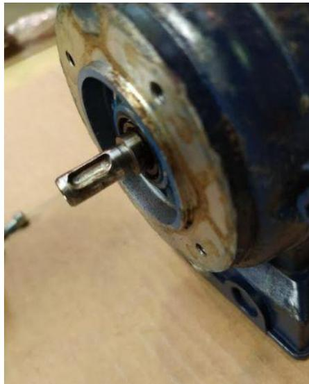
Figura 77. El chavetero que se ha deformado.
