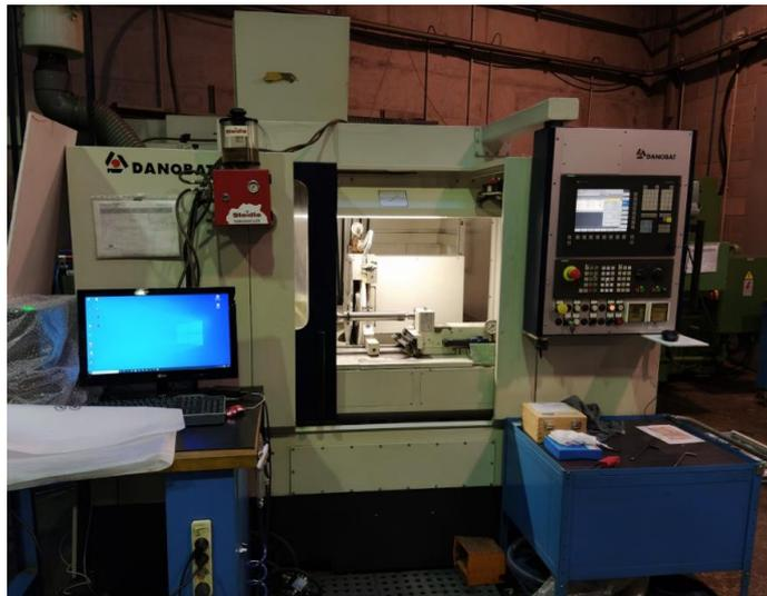
Figura 30. Rectificadora cilíndrica CNC de Danobat, modelo FG-600-S.
