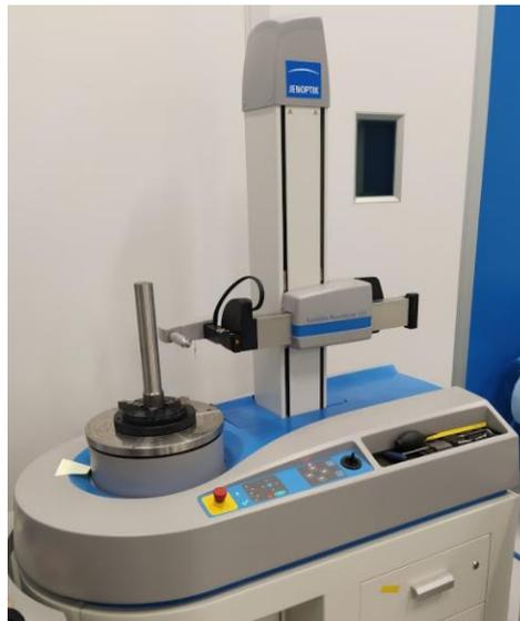
Figura 32. Una de las probetas colocadas en el perfilómetro.
