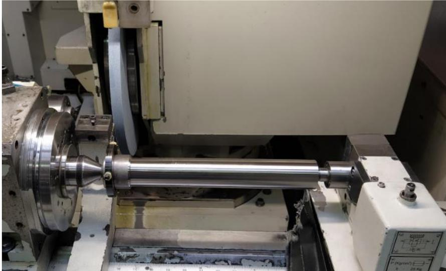
Figura 42. Amarre de una pieza en la rectificadora.
