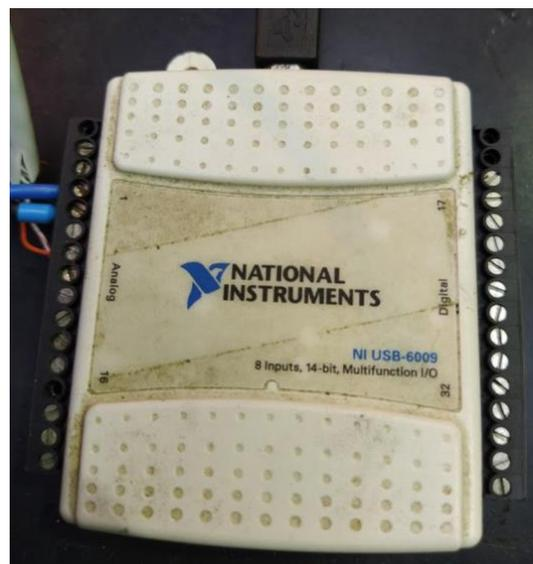
Figura 40. Tarjeta de adquisición de National Instruments.
