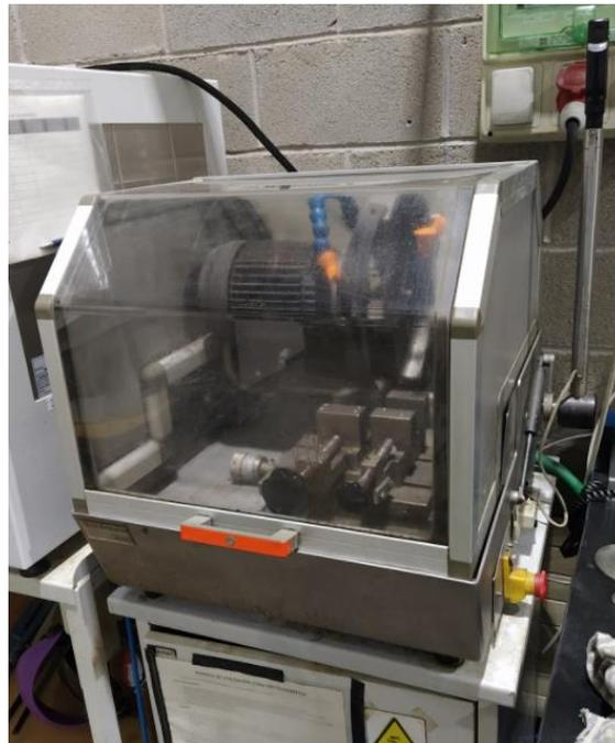
Figura 36. Sierra metalográfica utilizada.
