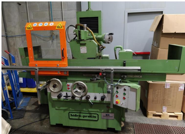
Figura 87. Rectificadora planeadora HIDRO-PRECIS.
