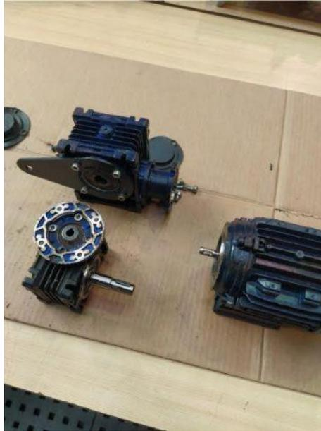
Figura 76. El motor y la reductora desmontados.
