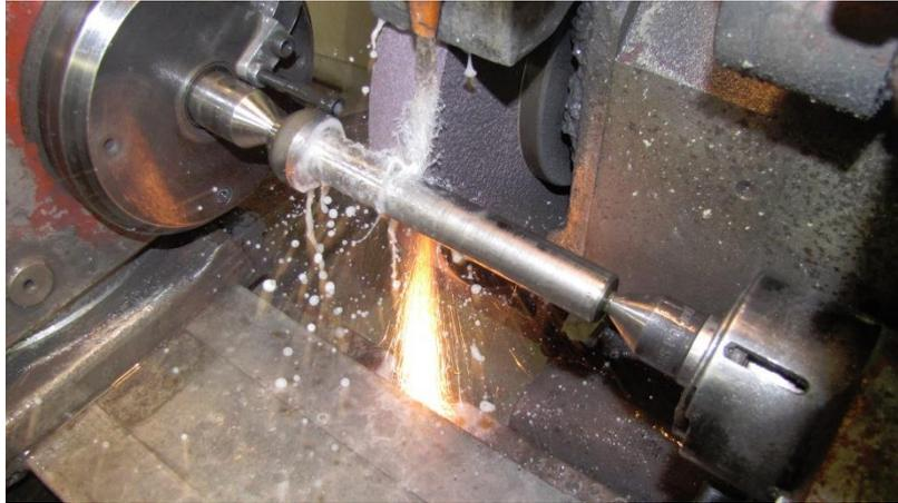
Figura 7. Ejemplo de rectificado cilíndrico. [4]
