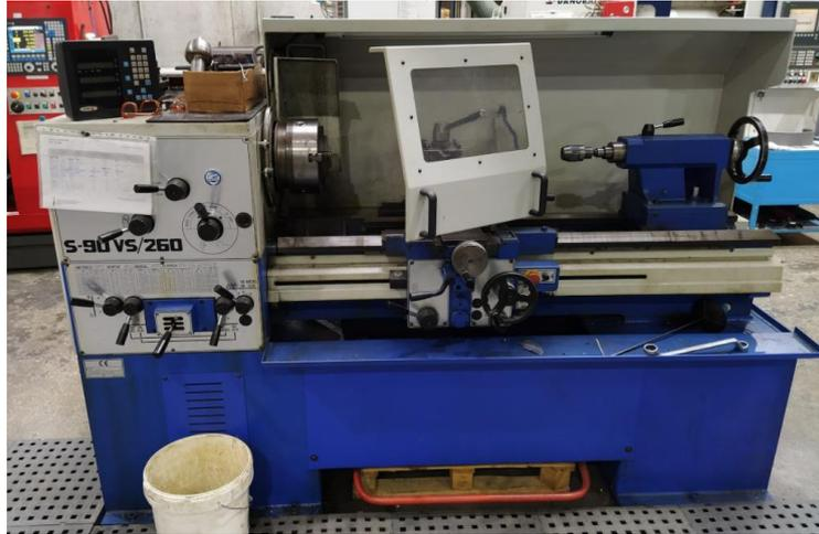
Figura 31. Torno convencional de Pinacho, modelo S90 VS 260.
