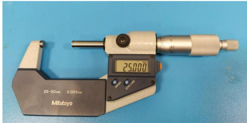
Figura 33. Micrómetro de exteriores digital de Mitutoyo.
