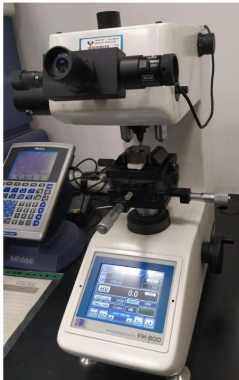
Figura 38. Microdurómetro utilizado en los ensayos.
