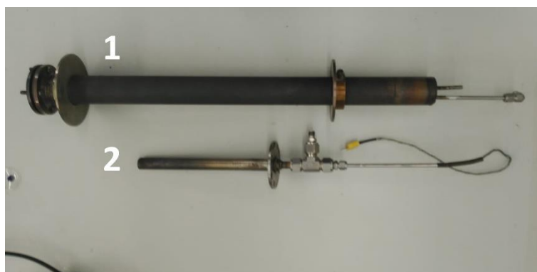
Figura 2.4. (1) Tubo externo de reacción, (2) tubo de reacción.
