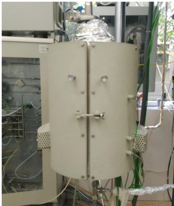
Figura 2.3. Horno de geometría cilíndrica de reacción.
