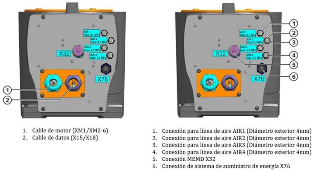
Figura 49. Conexiones de la base del robot KUKA KR3 R540.
